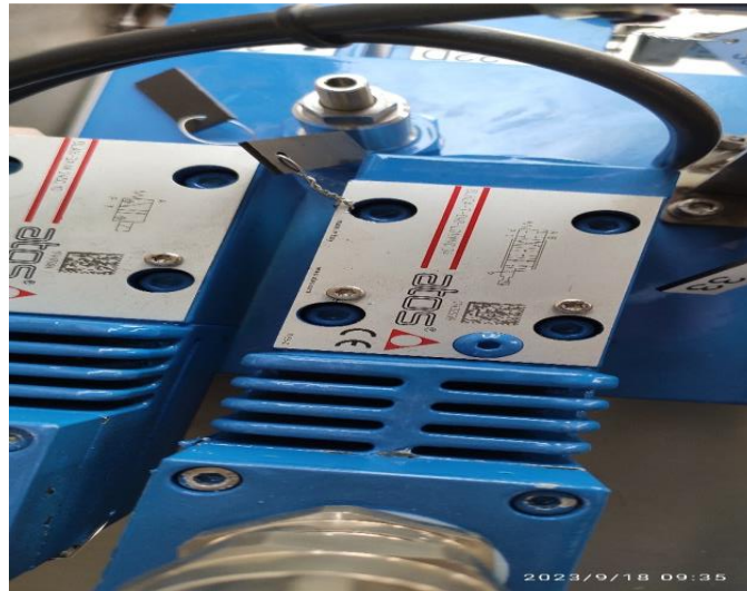
Figure I.12 : Le distributeur hydraulique de la centrale.
