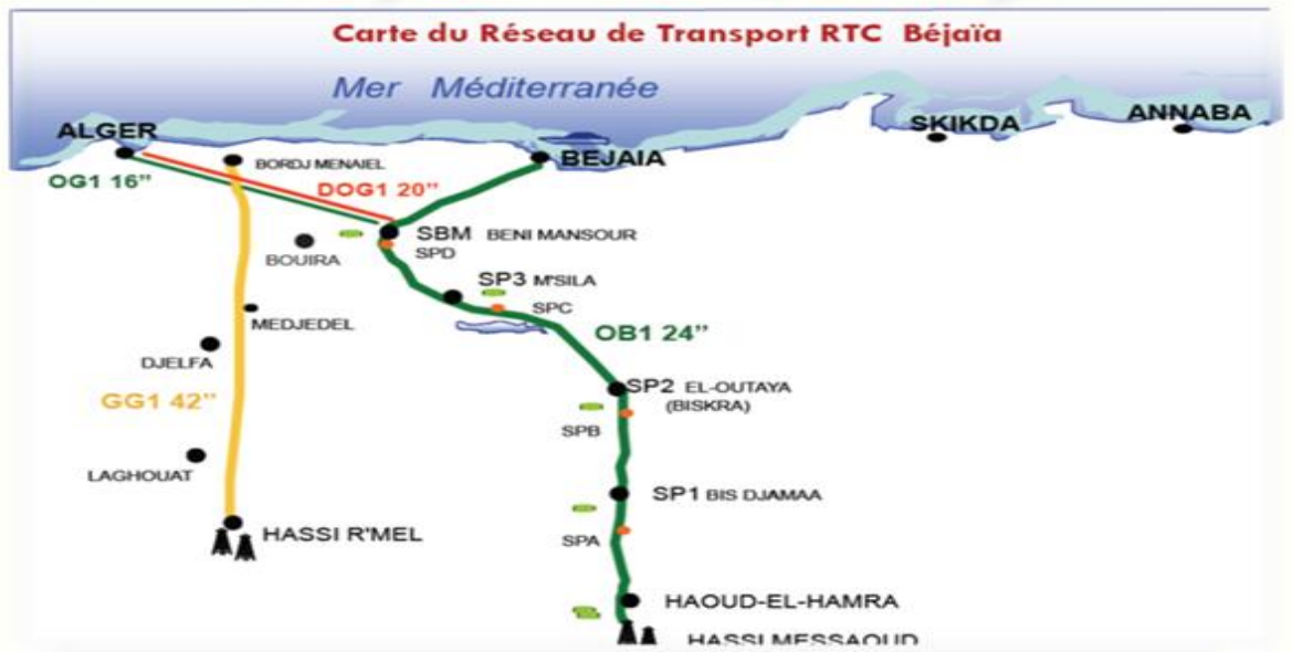
Figure .3 : Description des ouvrages de RTC [2].
