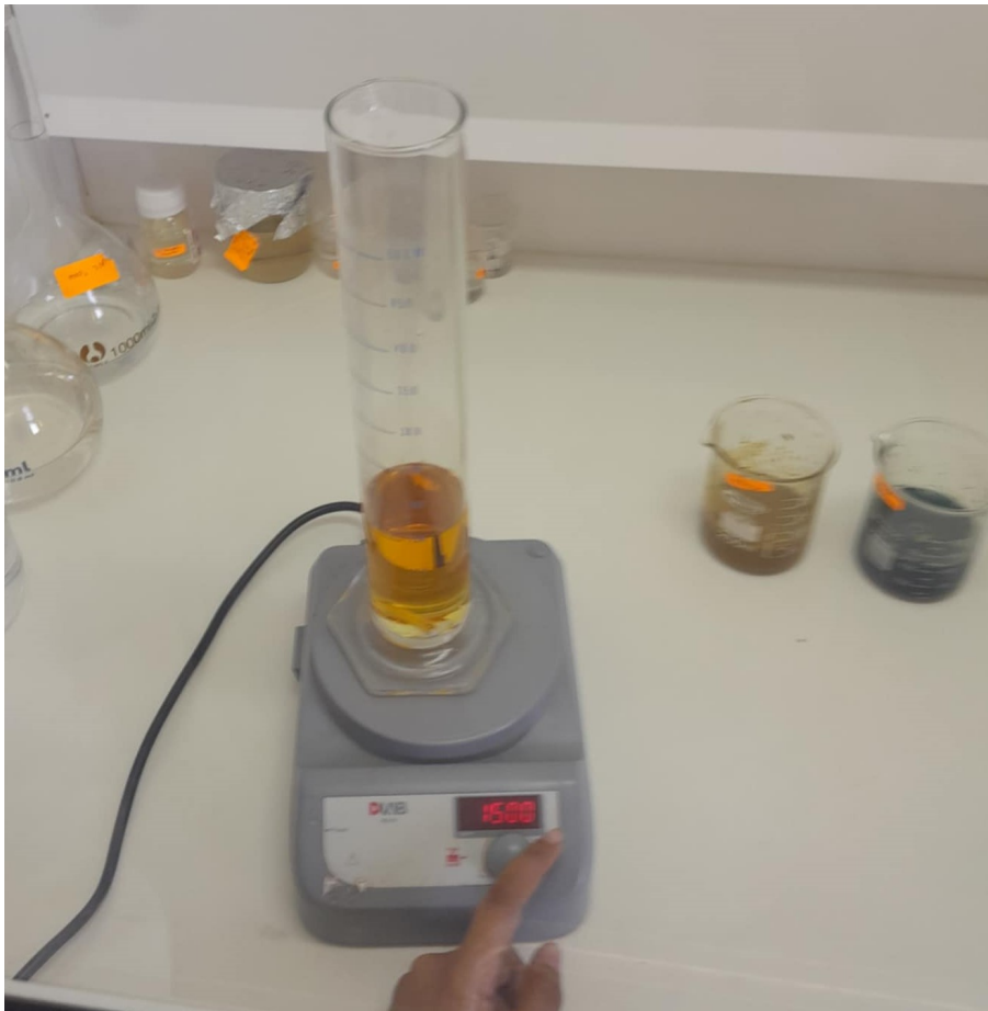
Figure III. 8 : Préparation de l'eau régale
