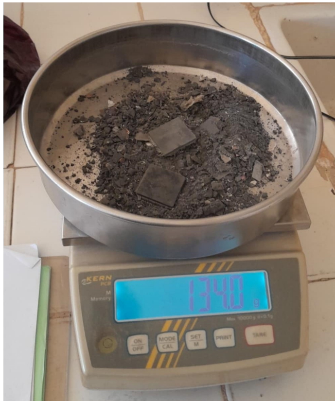
Figure III. 6 : Broyage des circuits intégrés (CI)
