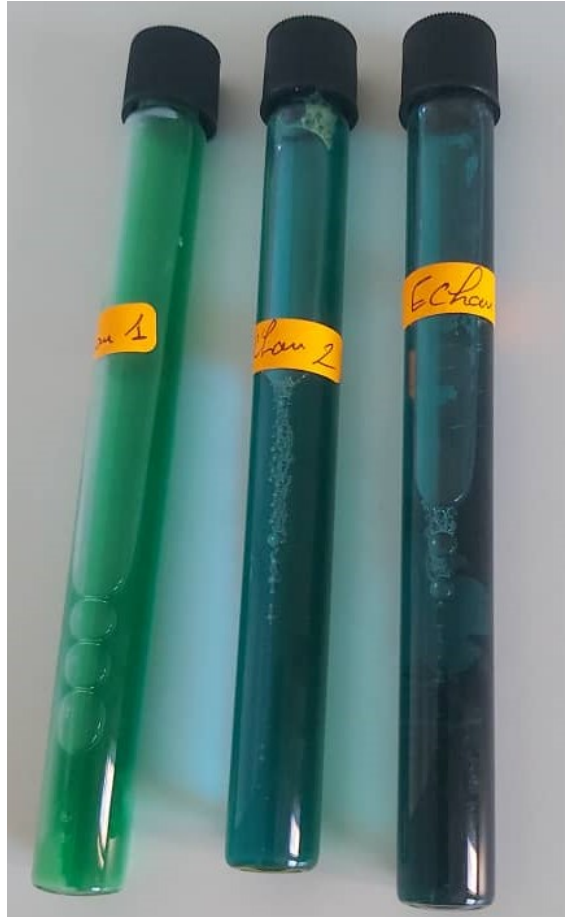
Figure IV. 1 : Solutions obtenues après lixiviation
