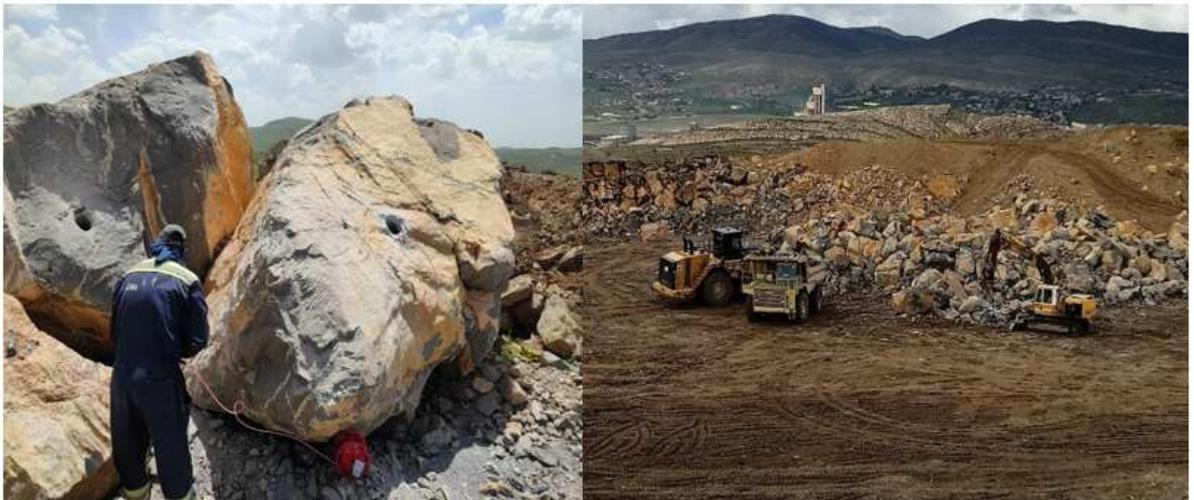
**Figure II.21** : Débitage secondaire par explosif et brise roche dans la carrière de Chouf Amar. Photo prise le : 22/04/2024.
