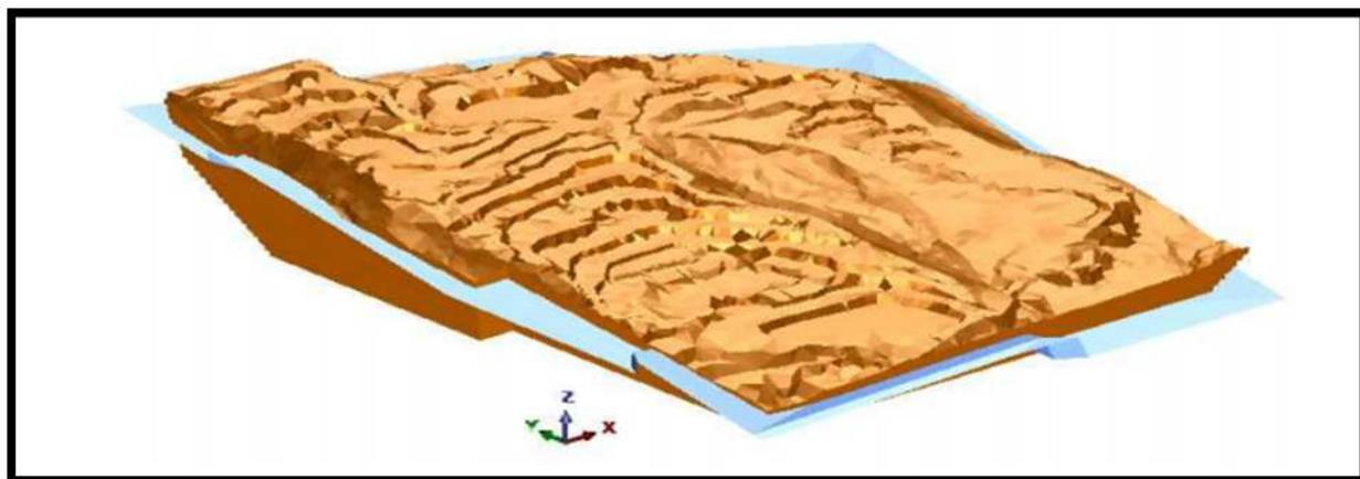
**Figure II.6 :** Intersection du solide représentant la matière avec le MNT du plancher d'exploitation.
