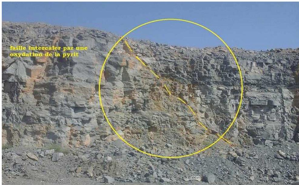
**Figure II.20** : présentation d'une faille intercalée au niveau 950 dans la carrière de Chouf Amar. Photo prise le : 28/04/2024.
