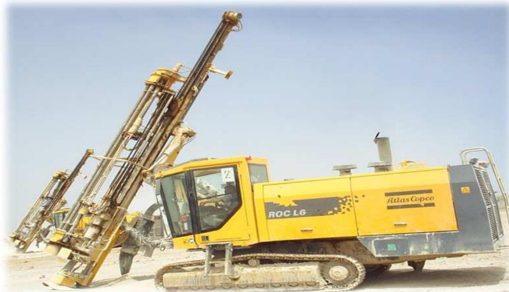
**Figure II.14 :** sondeuse ATLAS COPCO ROC L6.
