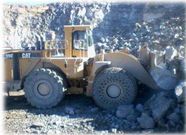
**Figure II.15** : chargeuse CARTER PILAR 990 IT
