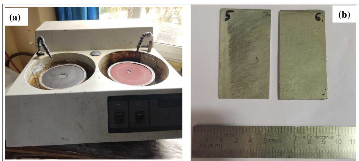
Figure 3.1 : (a) Polisseuse mécanique utilisée / (b) éprouvettes obtenus après polissage mécanique.
