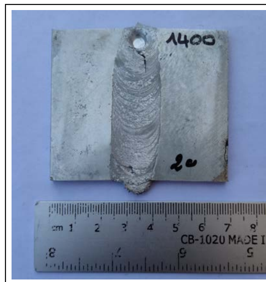
Figure 4.5 : Défaut de surface de type éraillures.
