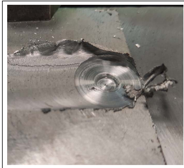
Figure 4.6 : Défaut flux de métal a racine du cordon de soudure.
