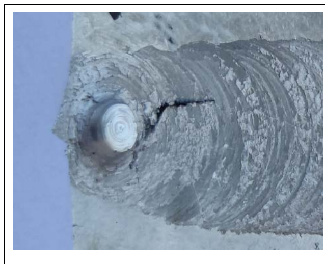
Figure 4.7 : Défaut tunnel interne.
