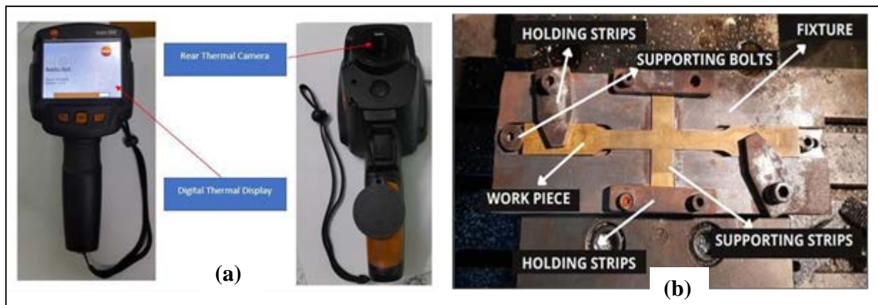
Figure 2.8 : (a) Imageur thermique / (b) Dispositif de fixation de l'échantillon pour le FSW
