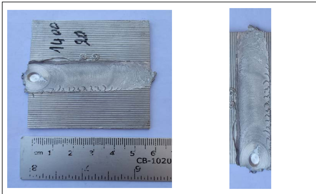
Figure 4.4 : Défaut de bavures excessives.
