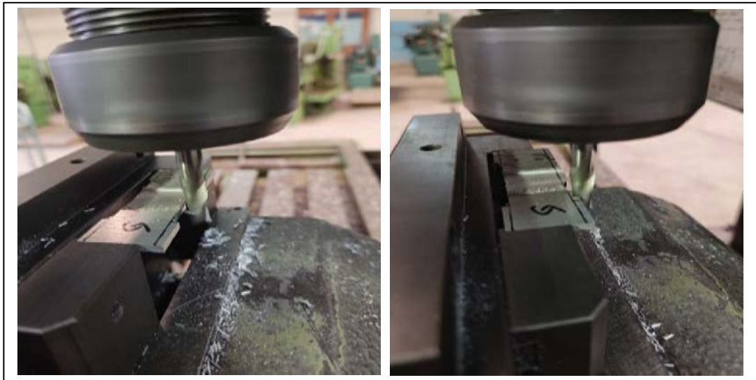
Figure 3.3 : Éprouvettes de traction usiné par une fraiseuse.
