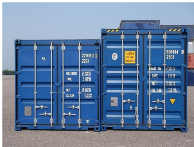
FIGURE 1.1 – La différence entre le conteneur standard et le conteneur high cube. [1]
