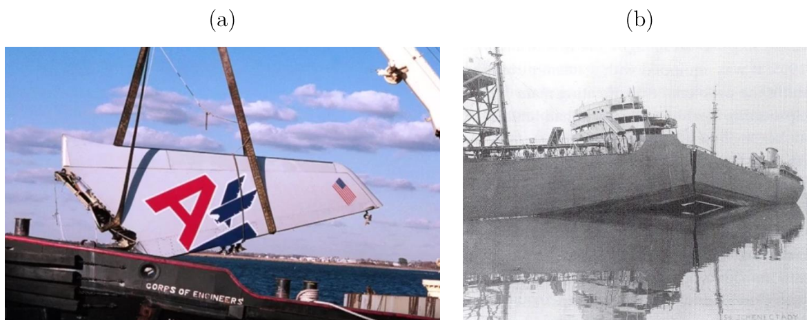
Fig. I-3 Catastrophes liées au phénomène de rupture (a) accident de l'avion American Airlines Airbus-A300 [12] (b) navire Liberty Ship [13].
