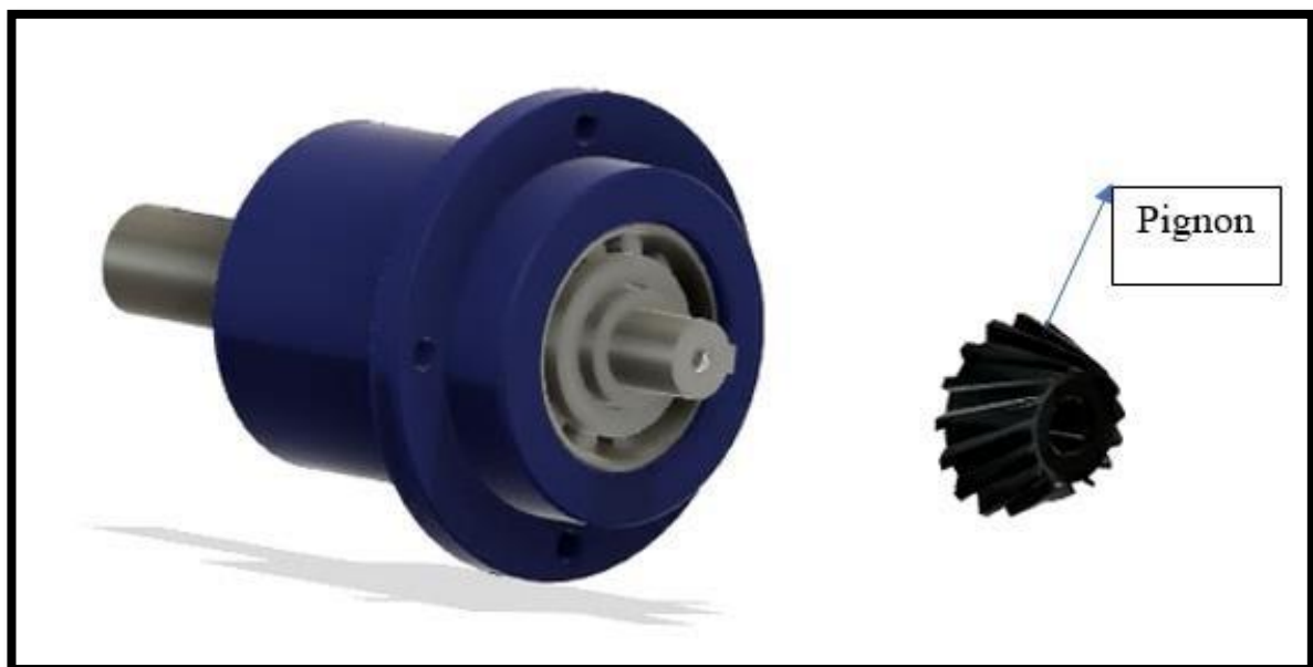
Figure 43 : Montage de pignon[4]
