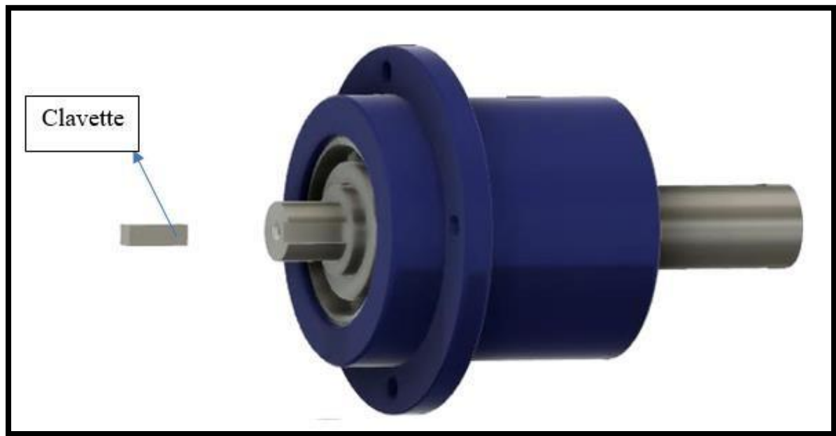
Figure 42 : Montage de clavette sur l'arbre[4]
