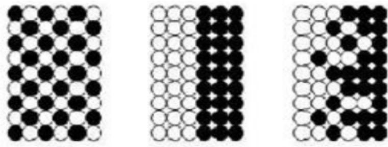
FIGURE 1.2 – La distribution composante des matériaux : à gauche, un matériau plan composé, au centre, un matériau relié, et à droite, un matériau à gradient de propriétés.
