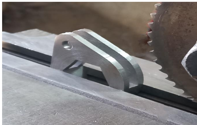
Figure V.11 : La réalisation de la rainure.
