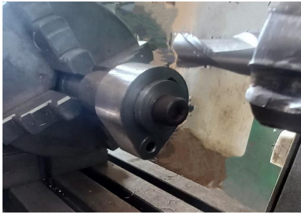
Figure V.10 : La réalisation de la forme ovale.
