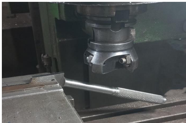
Figure V.7 : La réalisation des contours de la came.
