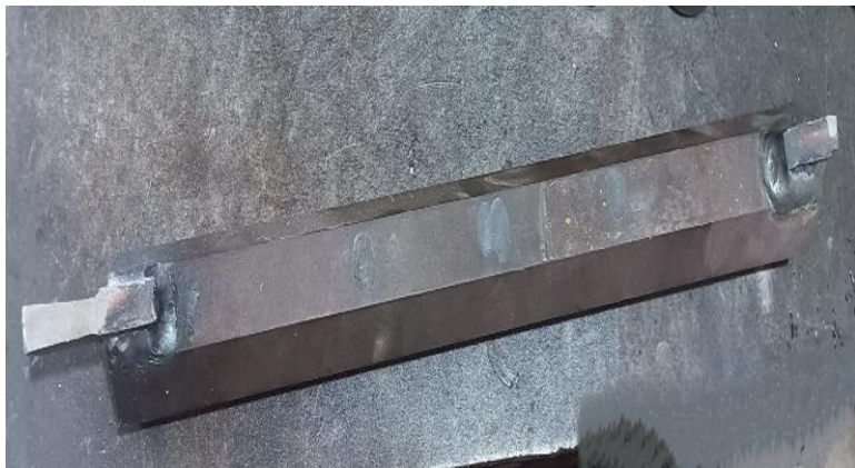
Figure IV.8 : Outil à mortaiser.
