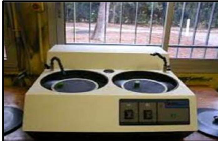
**Figure II.4 :** La polisseuse (Metaserv 2000).
