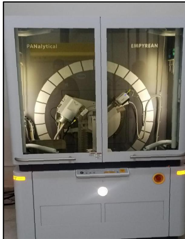
**Figure II.7 :** Dispositif Diffraction X : X'PERT PRO MRD de chez PANalytical.
