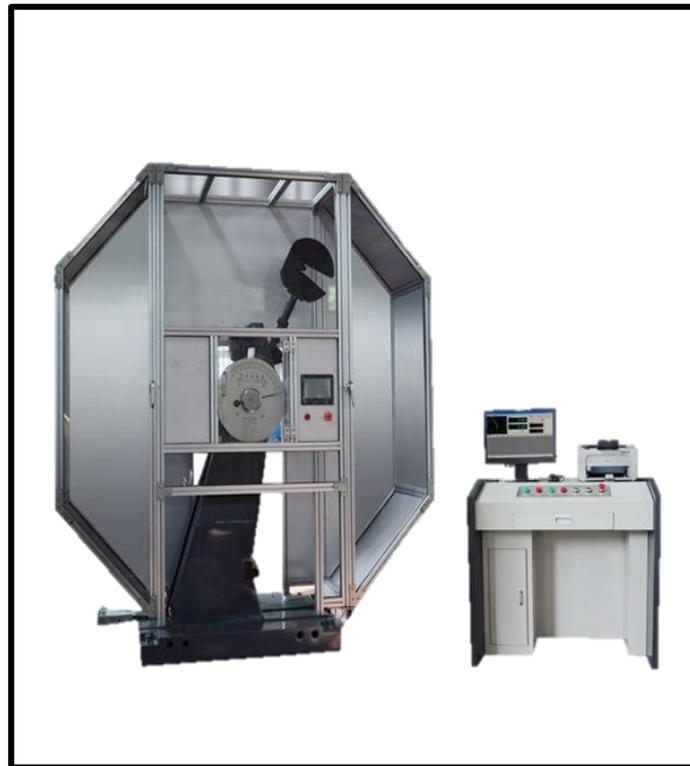
**Figure II.11** : Mouton pendule Charpy de capacité 750J.
