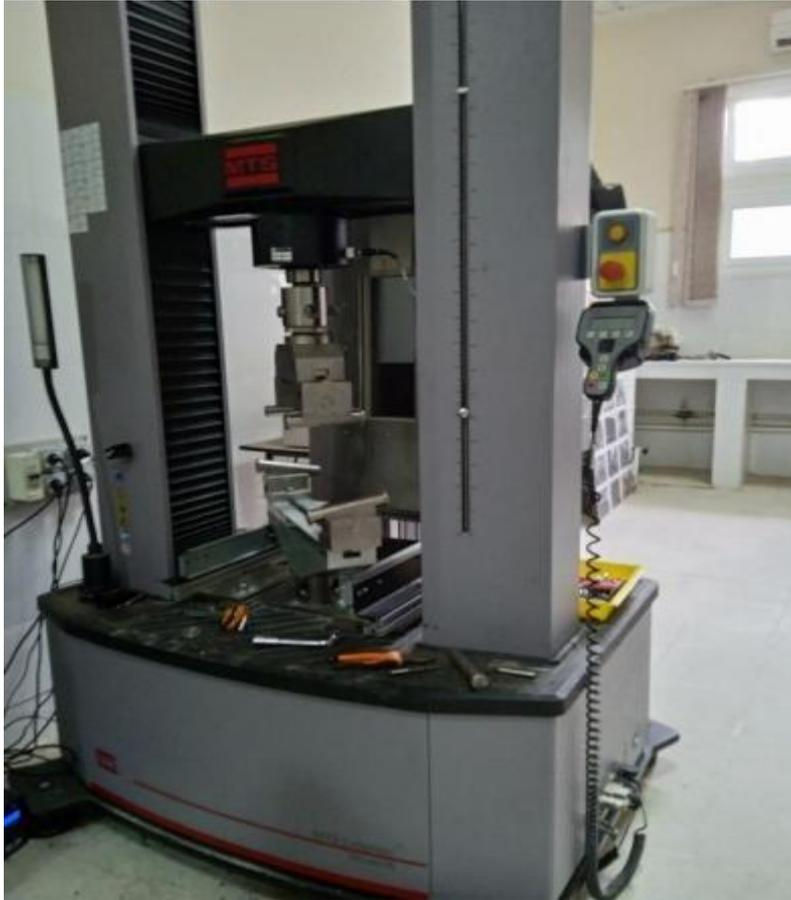
**Figure I. 13** : Machine de traction
