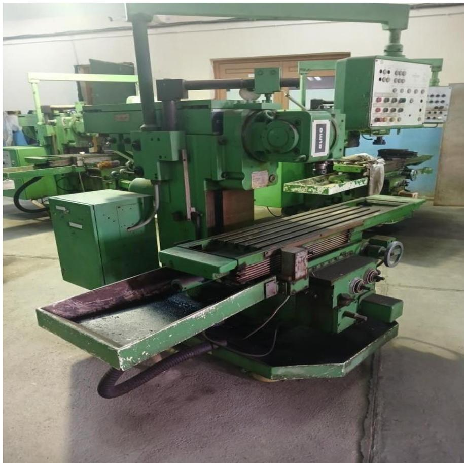
**Figure II. 3:** Fraiseuse horizontale conventionnelle.
