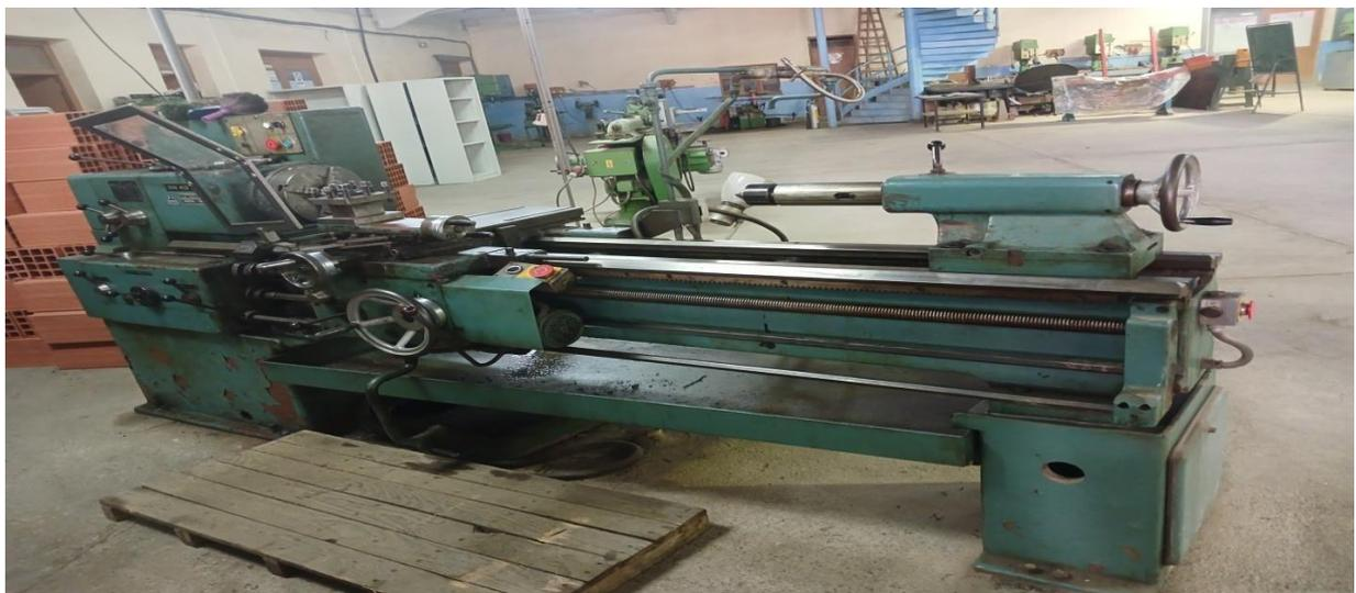
**Figure II . 2 :** Tour parallèle conventionnel
