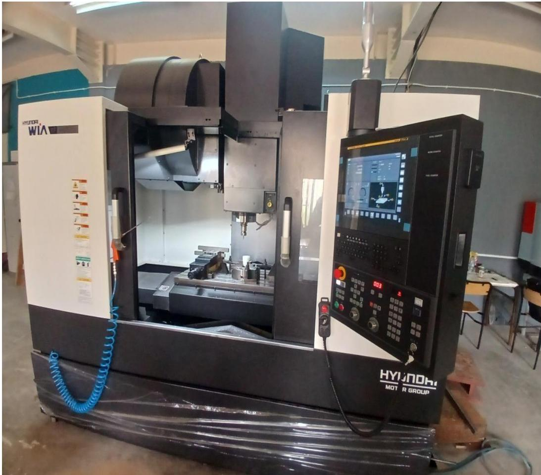
**Figure II. 7** : Centre d'usinage
