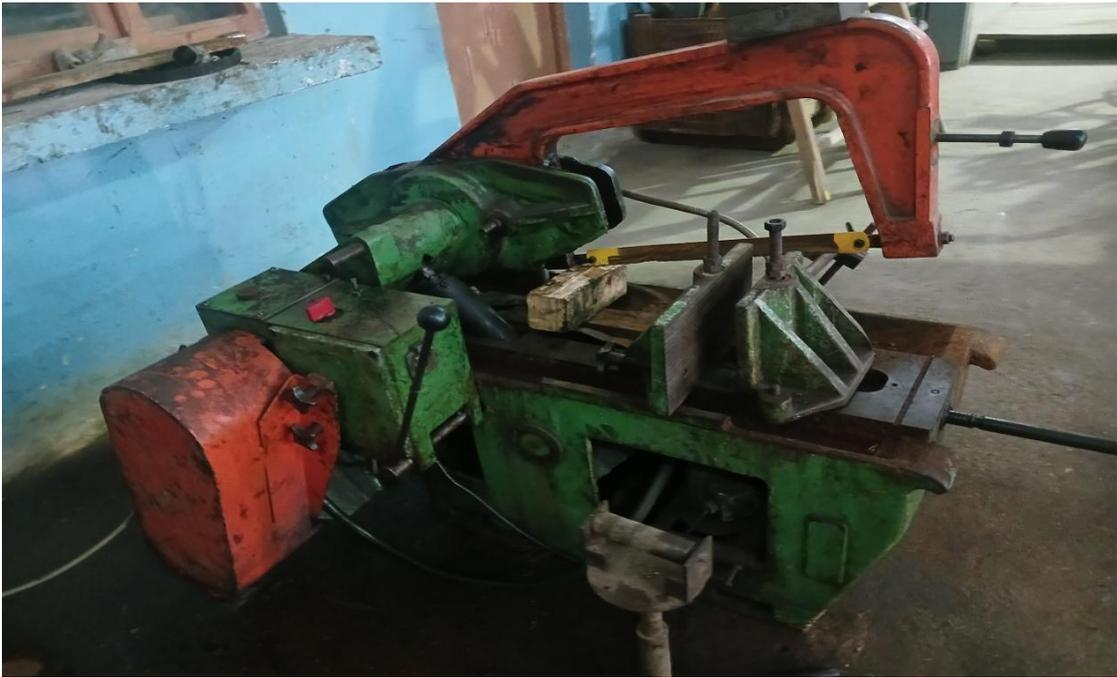
**Figure II. 1 :** Scie mécanique
