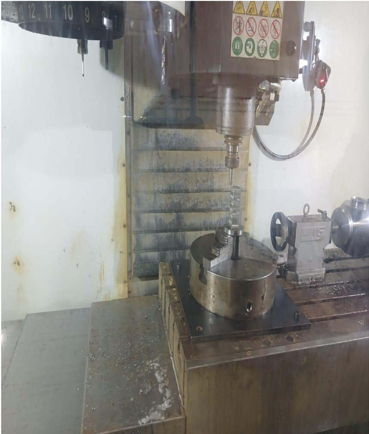
**Figure II . 6:** Enlèvement de matière par un centre d'usinage
