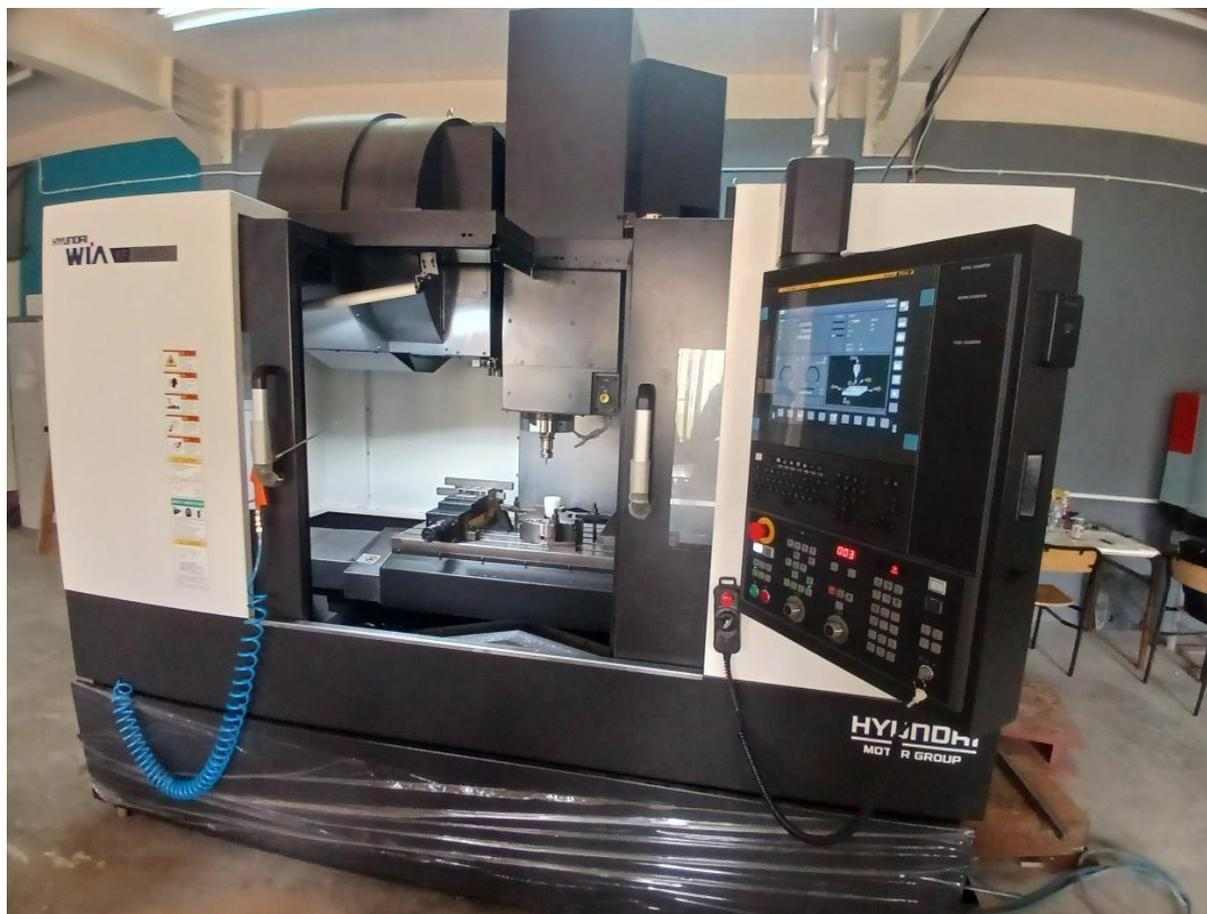
**Figure II . 5:** Centre d'usinage.
