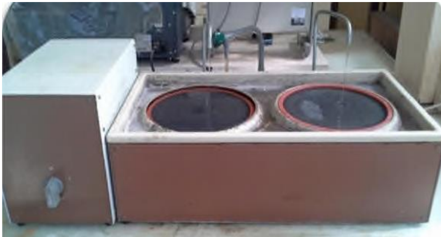
Figure II.4 : polisseuse sous jet d'eau
