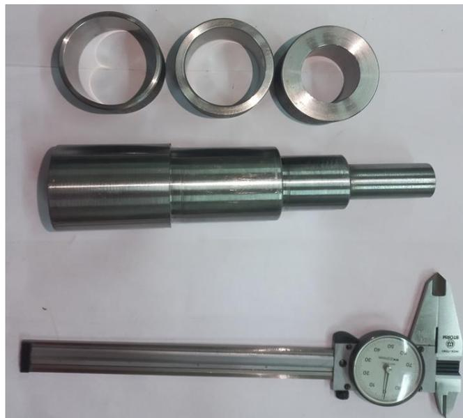
**Figure III.6** : contrôle géométrique et dimensionnel des pièces.
