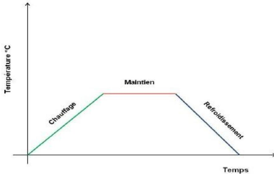
Figure I.14 : Diagramme de base d'un traitement thermique de trempe
