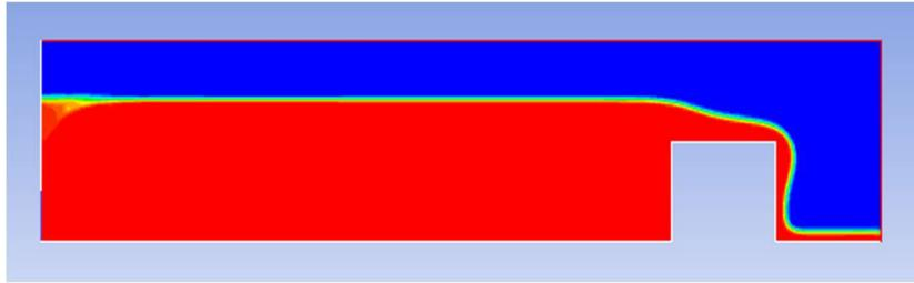
**Figure IV.9 :** Contours des phases pour  $Q=80$  l/s
