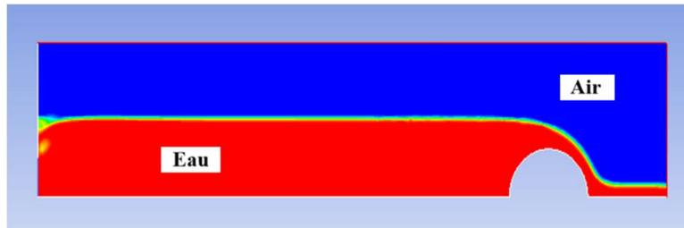
**Figure IV.42 :** Contours des phases pour  $Q=100$  l/s
