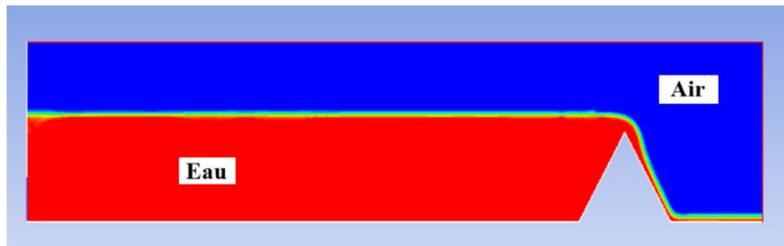
Figure IV.21 : Contours des phases pour  $Q=60$  l/s
