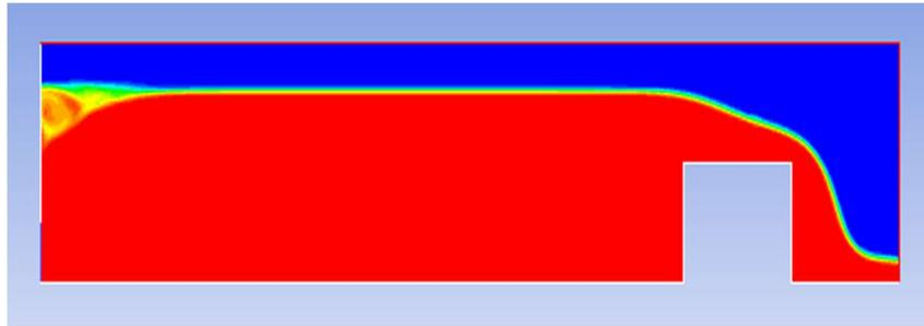
**Figure IV.15 :** Contours des phases pour  $Q=120$  l/s
