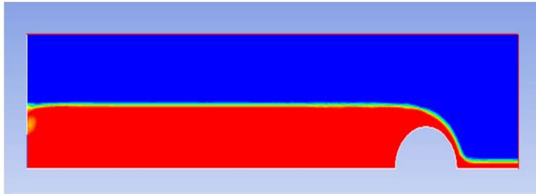
**Figure IV.39** : Contours des phases pour  $Q=80$  l/s
