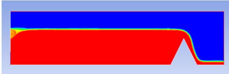
**Figure IV.27 :** Contours des phases pour  $Q=100$  l/s
