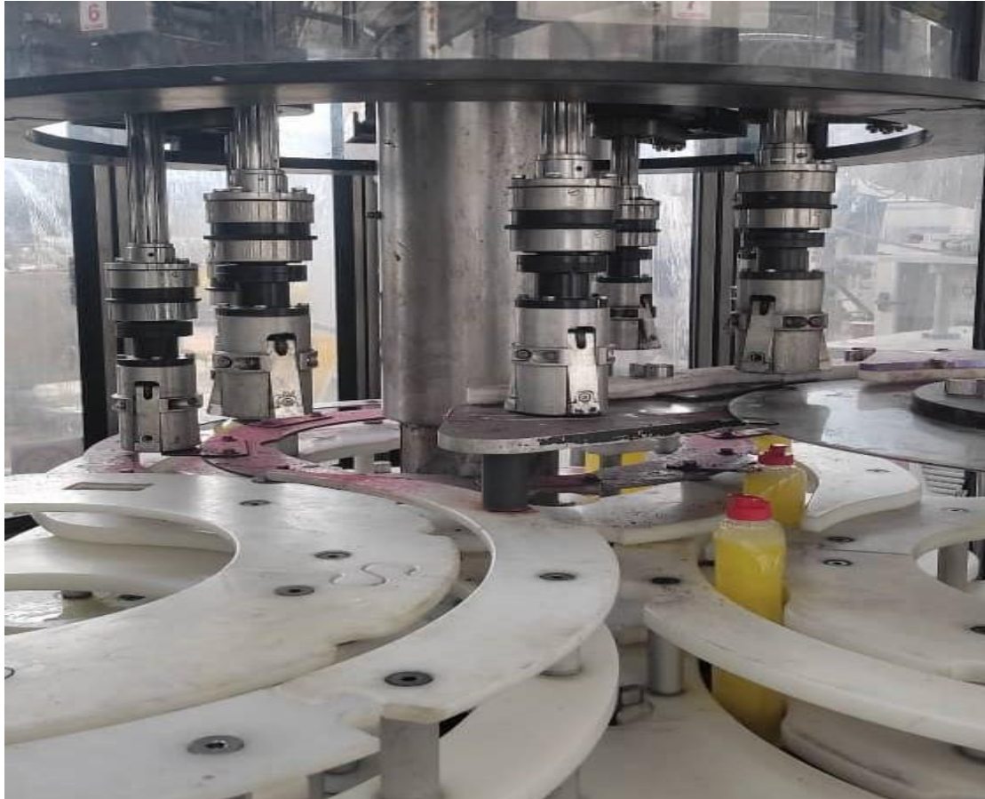
Figure II.3 : Vue de la tête visseuse sur la machine « Ronchi ».
