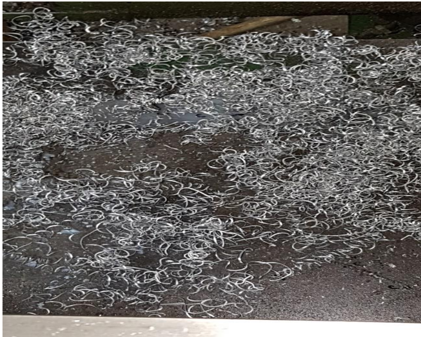
Figure IV. 1 : les copeaux obtenus après usinage sur un tour.
