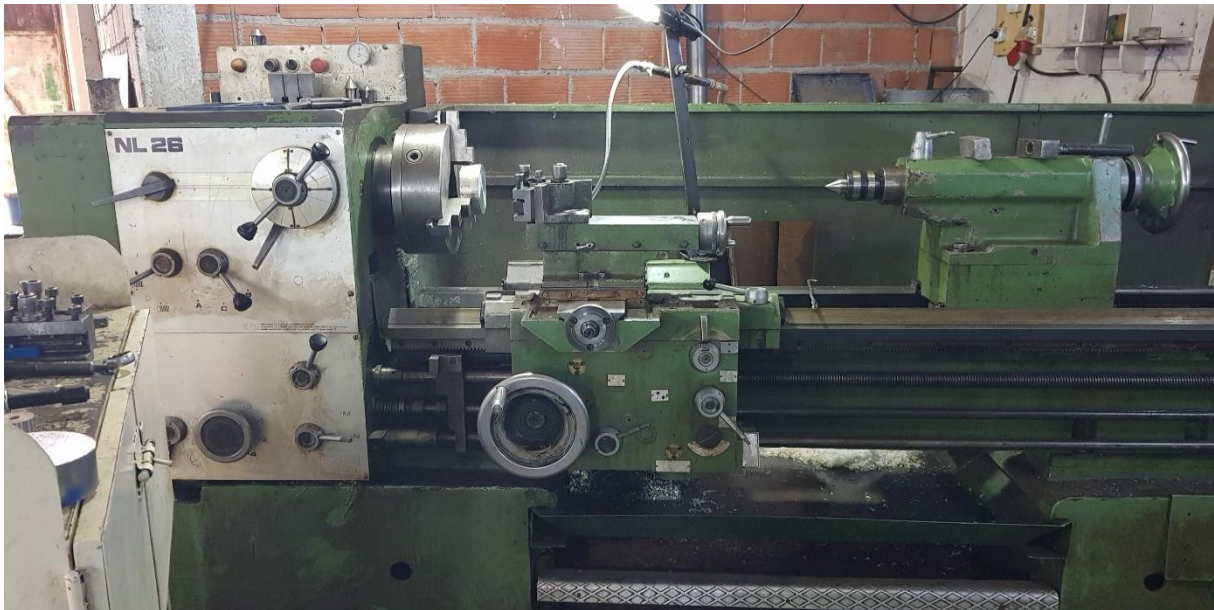
Figure I-3 : tour conventionnel NL 26(entreprise FMIPA Fabrication mécanique -Akbou)
