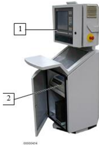
Figure III. 11. : Le poste de contrôle et de commande (P.C.C.)
