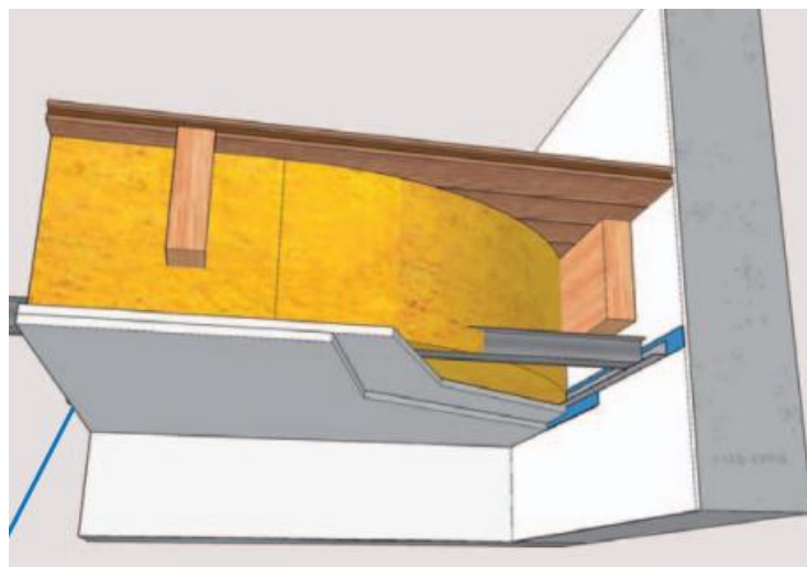
Figure 34: Doublage faux-plafond. (Source : ADEME, 2020)
