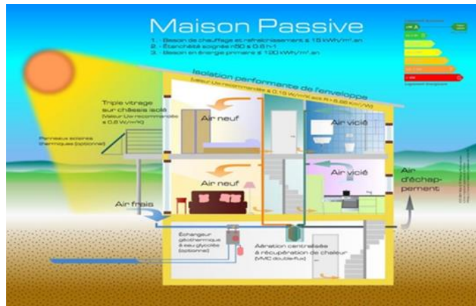
Figure 17: Schémas d'une maison passive. (Source : www.constructeurs-maisons.org ,2023)
