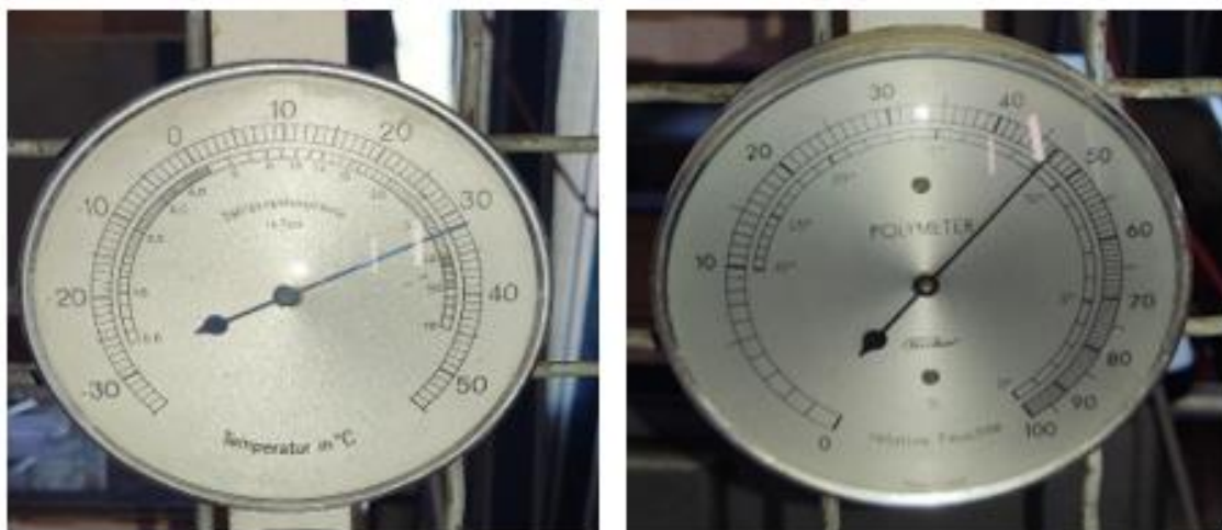
Figure II. 10: un thermomètre à aiguille utilisé pour mesurer la température et un hygromètre à cheveux utilisé pour mesurer l'humidité.
