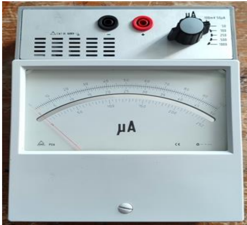
Figure II. 6 : Microampèremètre à aiguille utilisé dans la mesure du courant de décharge.
