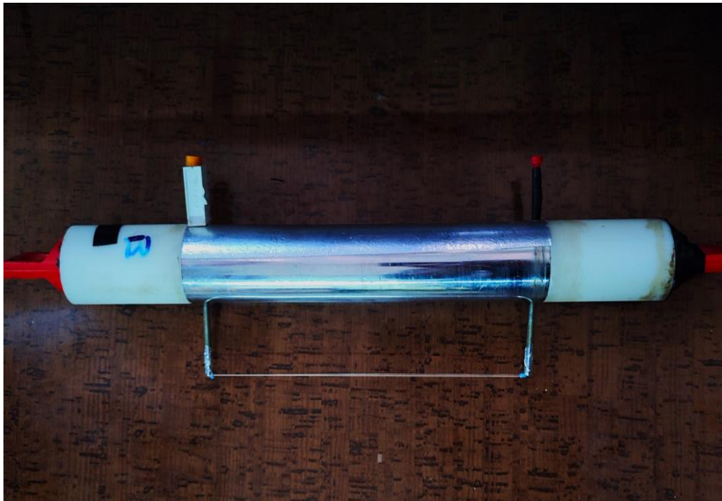
Figure II. 12: Dispositif expérimental configuration Duale (fil-cylindre).
