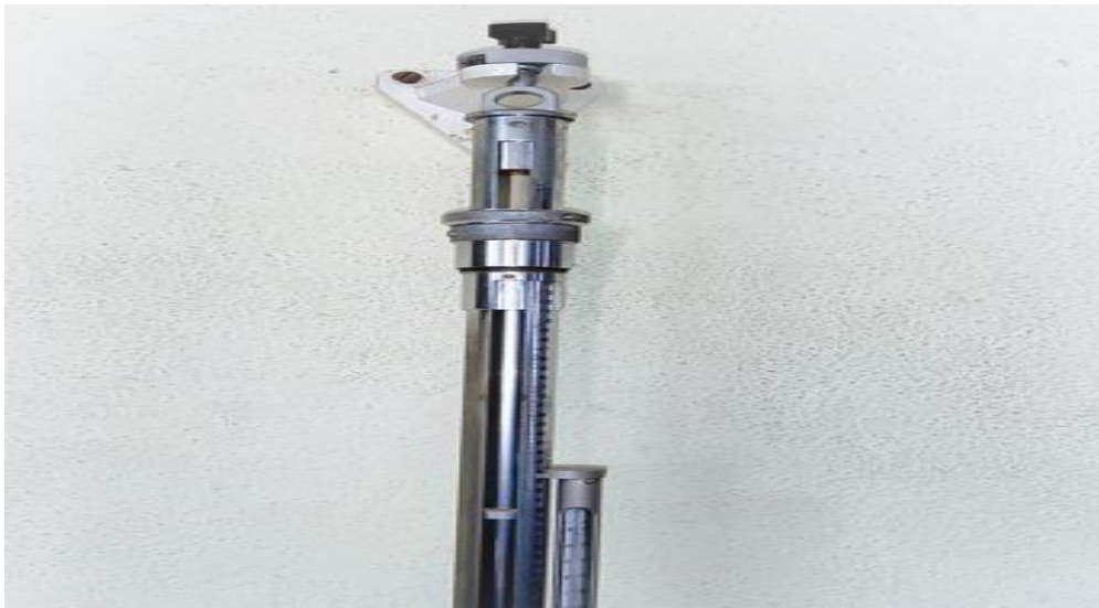
Figure II. 9: baromètre à mercure utilisé pour mesurer la pression.
