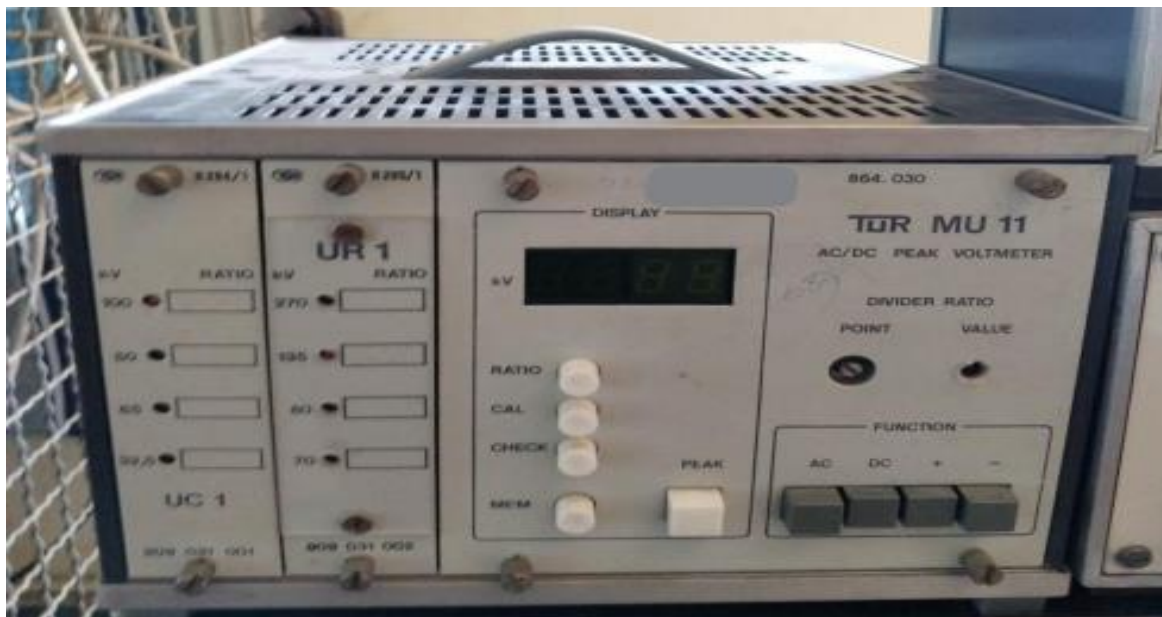
Figure II. 5: Photo du voltmètre de crête MU11.
