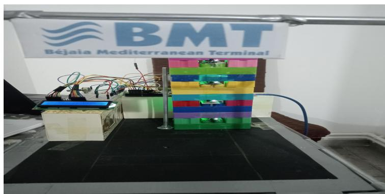
FIGURE 4.11 – Prototype de détection des emplacements vides
