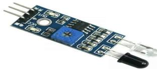
FIGURE 4.7 – Capteur infrarouge.
