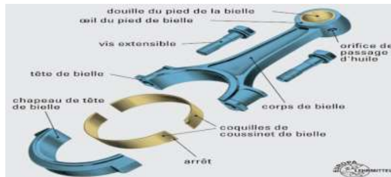
Figure.1.11 : les composantes de la bielle.
