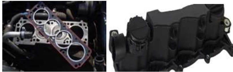
Figure.1.8 : joint de culasse et Couvre de culasse.
