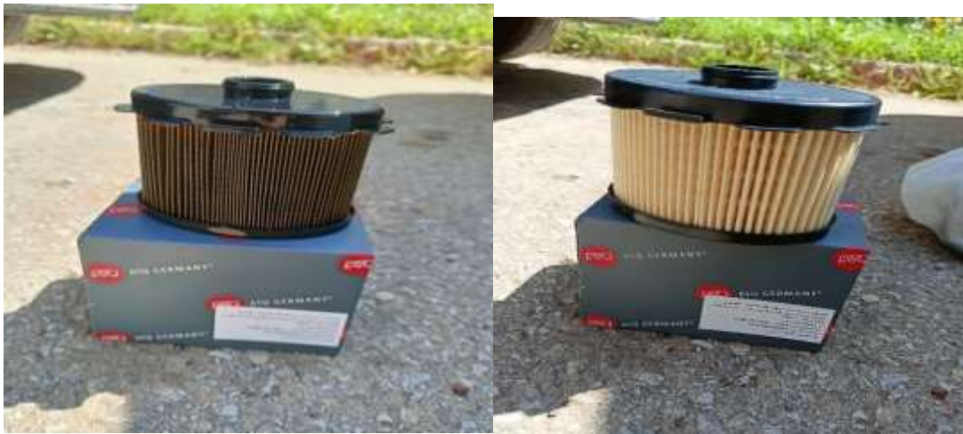
Figure 2.11 : Filtre à gasoil encrassé et neuf.
