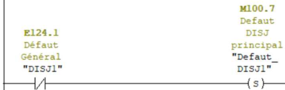
Réseau 3 : DEFAUT DISJ PRINCIPAL
