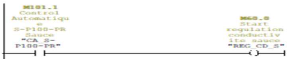
Réseau 9 : Conditions arret remplissage T04
