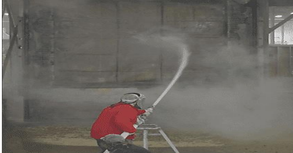
Figure I.9 : Le moniteur Hose Stream [16]
