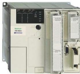
Figure III.3 : Automate programmable industrielle [8]
