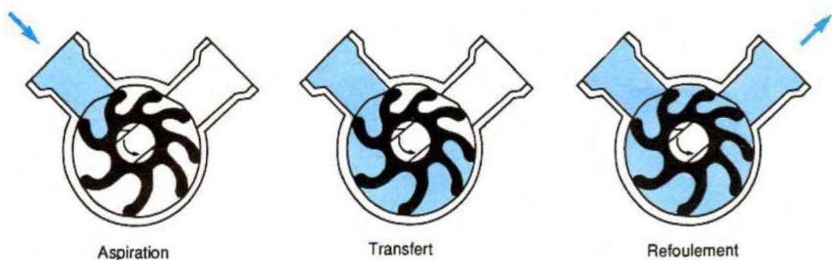
Figure II.8: Pompe à palettes flexibles.
