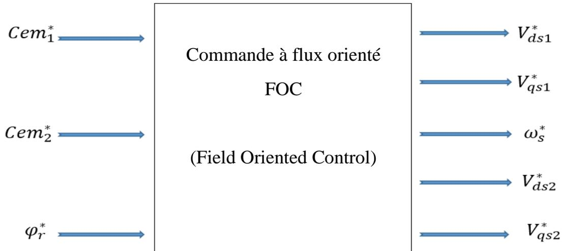
**Figure (III. 2) :** Schéma bloc simplifié de la commande à flux orienté (FOC)
