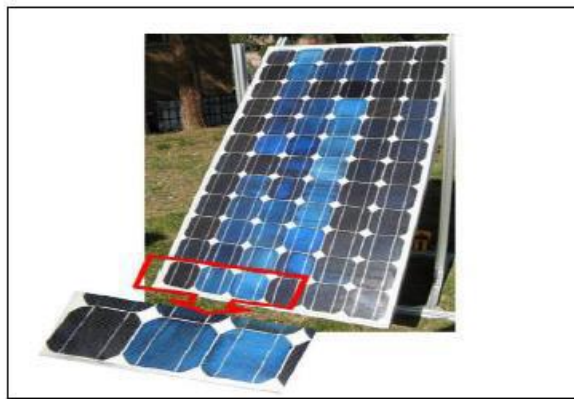
Figure II.6 : Défaillance de revêtement anti-reflet [30].
