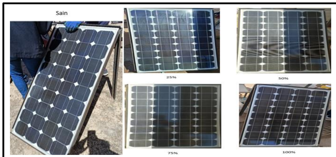
Figure III.12 : Défauts d'ombrage avec différents pourcentages.
