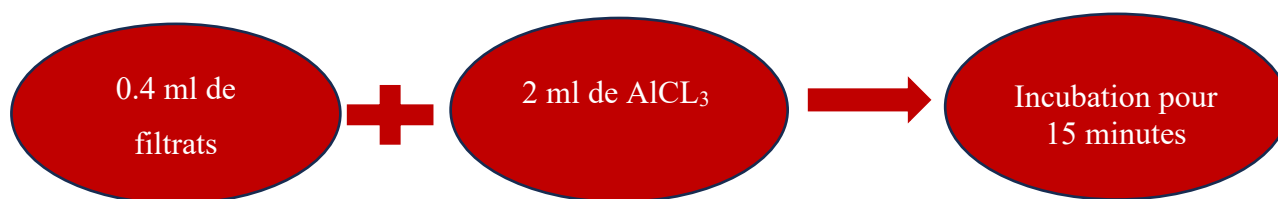
Figure.III.18 : Schéma de dosage des flavonoïdes essais de l'encapsulation de l'écorce de grenade.
