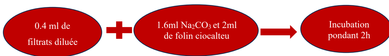
Figure.III.17 : Schéma de dosage des essais de l'encapsulation de l'écorce de grenade.
