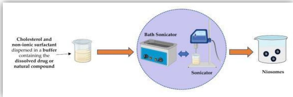
**Figure III.7.** Schéma illustratif pour la formulation de niosomes avec la technique de sonication
