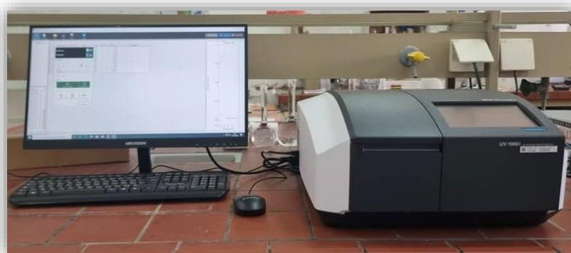
**Figure V.3.** Présentation d'un spectrophotomètre UV visible.
