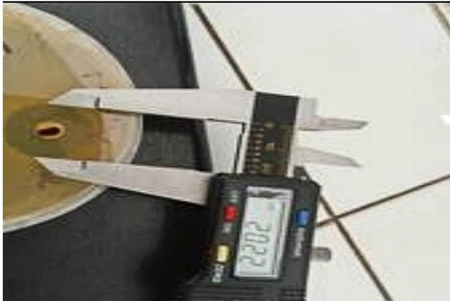
**Figure IV.17** : Mesure du diamètre d'inhibition à l'aide d'un pied à coulisse.
