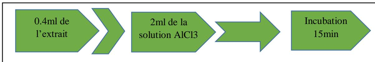
**Figure III.13** : Schéma des étapes pour le dosage des flavonoïdes dans les extraits du *ficus de microcarpa*
