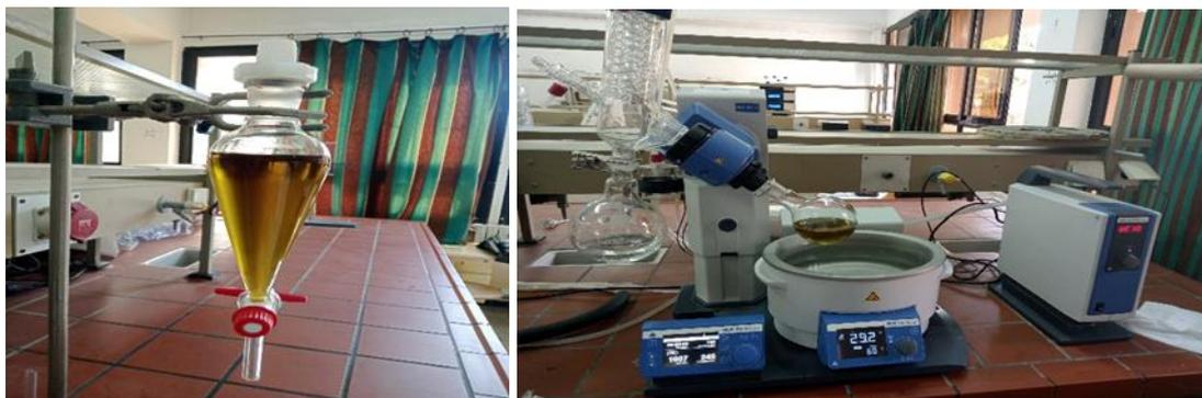
Figure III.22: Extraction par le dichlorométhane et évaporation par le rotavapeur.
