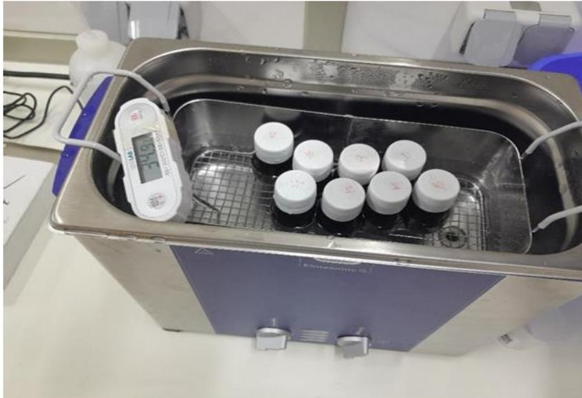
**Figure 05:** Bain ultrason utilisé (ELmasonic S60H).
