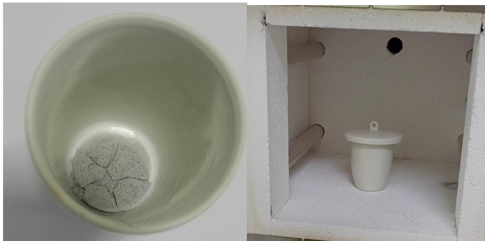
Figure N° 13 : Détermination de la teneur en cendre.
