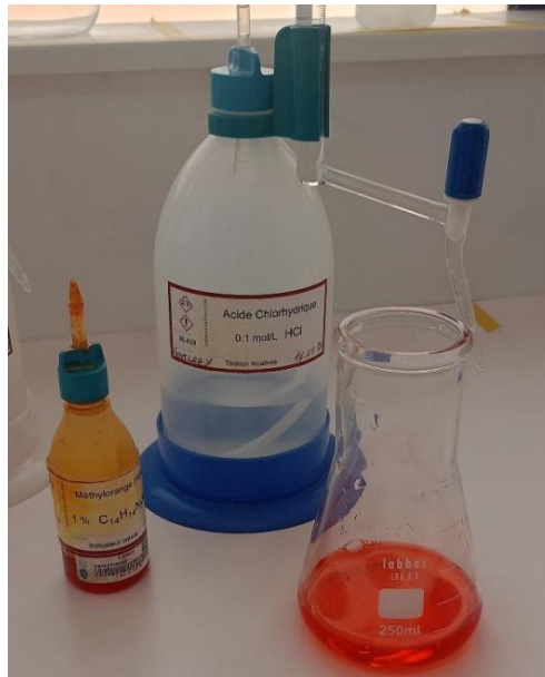
Figure N° 18 : Détermination du TAC « virage de la couleur »
