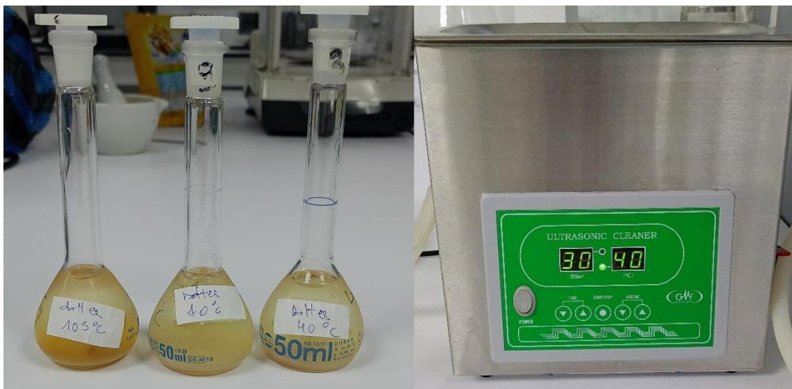
Figure N° 16 : Extraction des composés phénoliques dans un bain ultrasons
