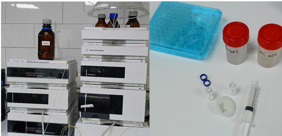
Figure N° 14 : Détermination de taux de sucres par HPLC.
