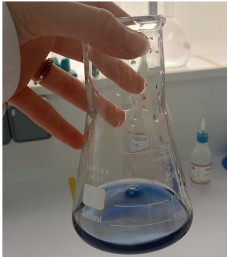
Figure N° 17 : Détermination du titre hydrotimétrique TH « virage de la couleur »
