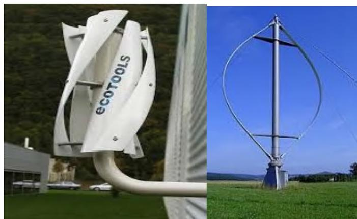
Figure 5: Eolienne à axe vertical, (a) type Savonius, (b) type Darrieus[09].
