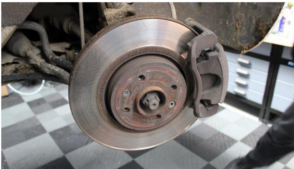
Figure 3: Disque et plaquette de frein d'une voiture
