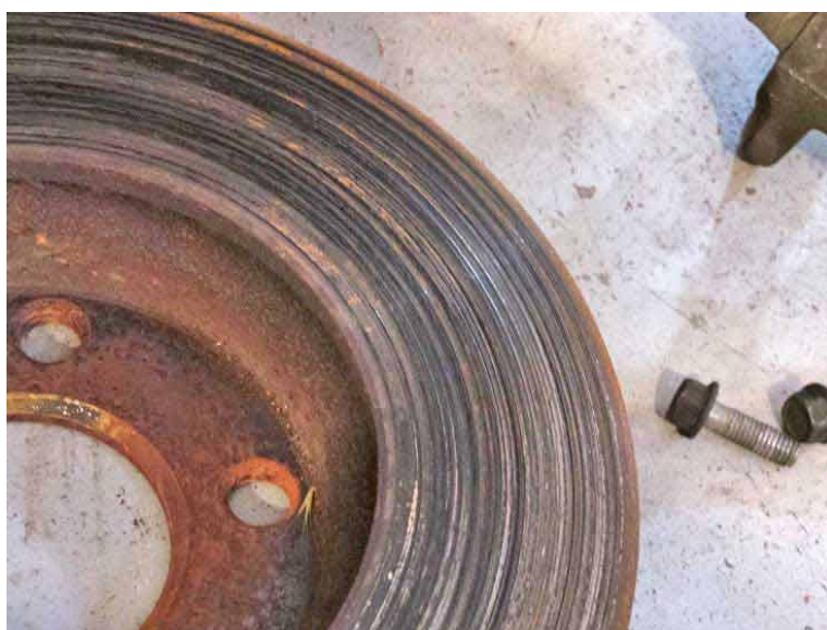
Figure 16: Disque de frein usé
