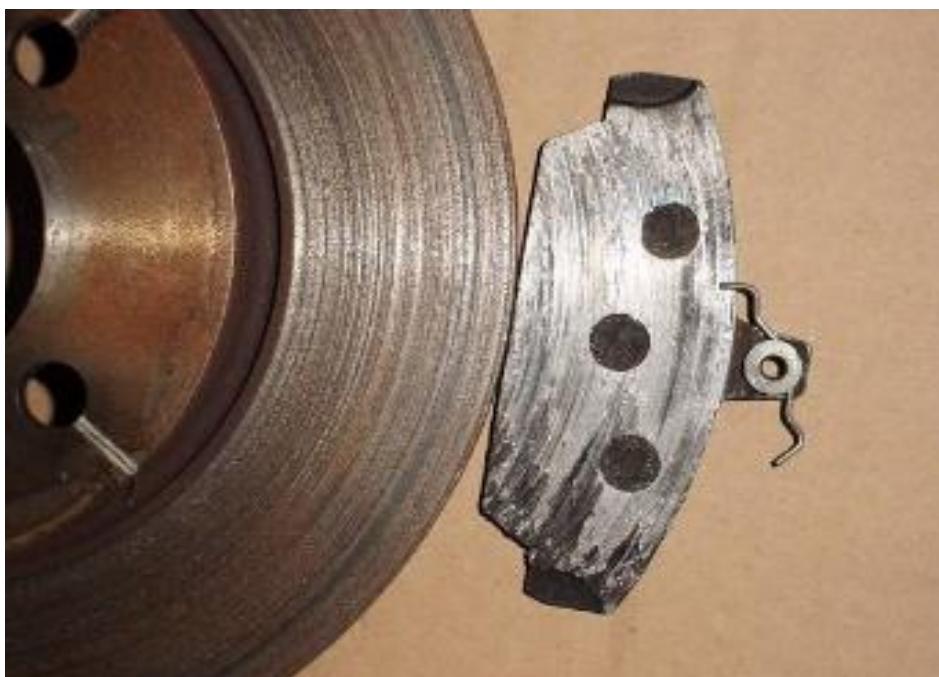
Figure 15: disque et plaquette de frein usée
