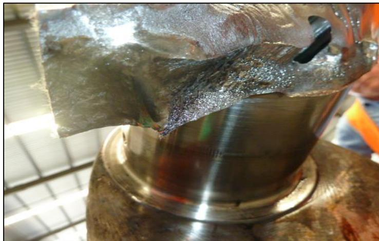
**Figure. I.3.** rupture d'un arbre par fatigue
