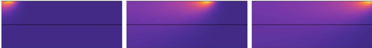
Figure IV.1 : déplacement de la source laser mobile sur la plaque d'acier.
