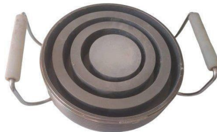
Figure II. 4. Dispositif de broyeur à disques et anneaux oscillants.
