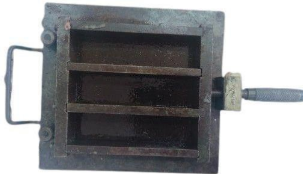
Figure IV. 3. Moule du mortier (Labo de Génie civil béton Bejaia)
