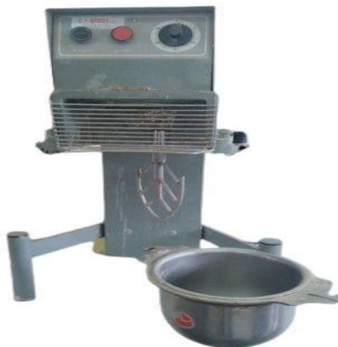
Figure IV. 2 .Matériel du malaxage du mortier
