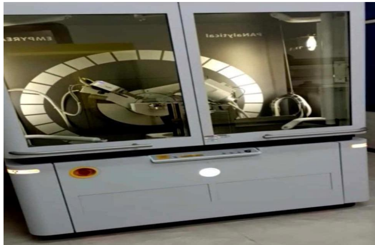
Figure II. 10. Diffractomètre à RX (CRAPC-BEJAIA)
