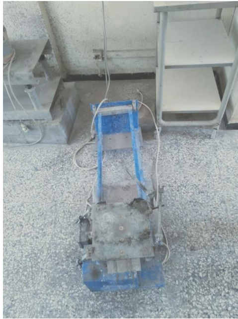
Figure IV. 4. Agitateur d'éprouvettes (table à choc). (Labo de Génie civil Bejaia)
