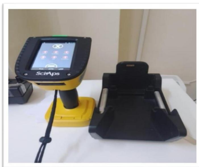
Figure II. 8. Spectromètre à fluorescence X (de marque Scias)
