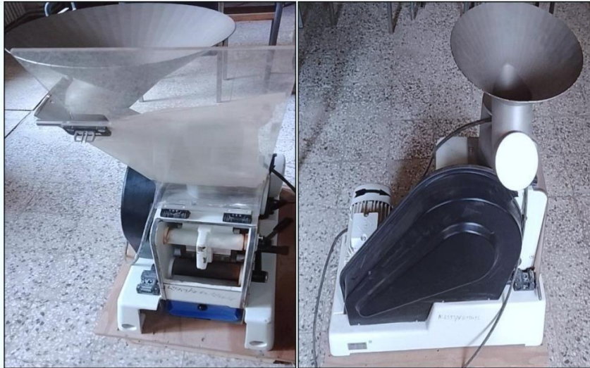
Figure II. 1 .Concasseur à mâchoire (laboratoire préparation mécanique)
