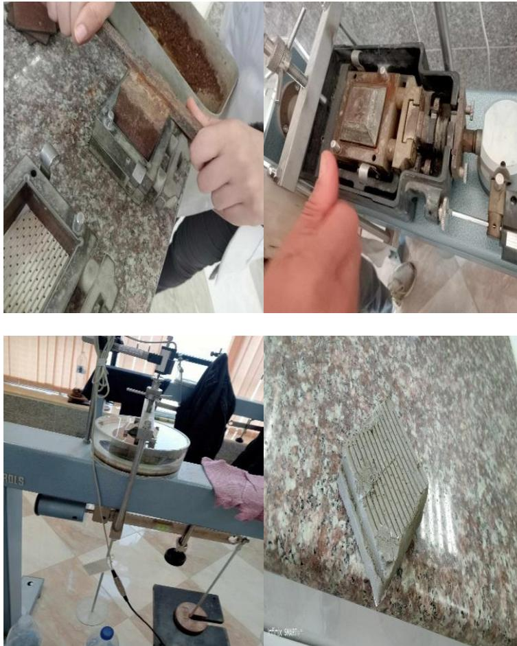
Figure 2 – 33 : Les étapes de L'essai Cisaillement.
