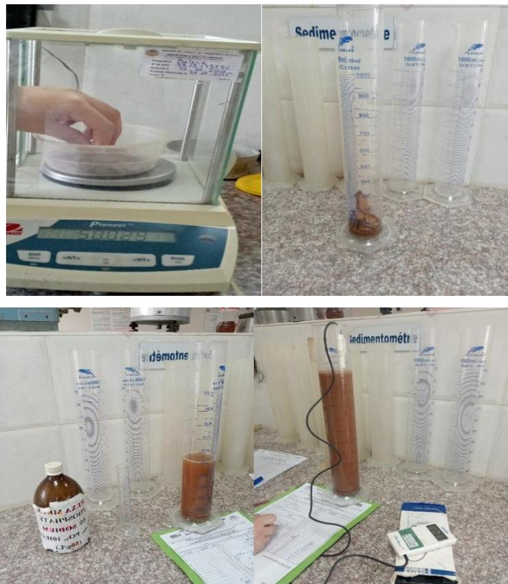
Figure 2-17 : Les étapes de L'essai Sédimentométrie.
