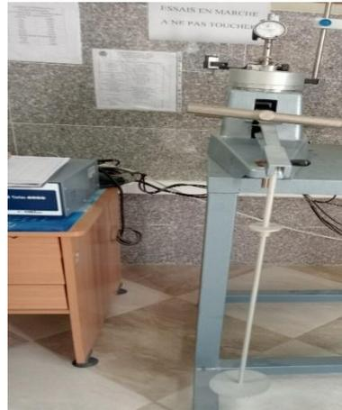
**Figure 2-34** : Moule œdométrique métallique    **Figure 2-35** : Machine œdométrique.
