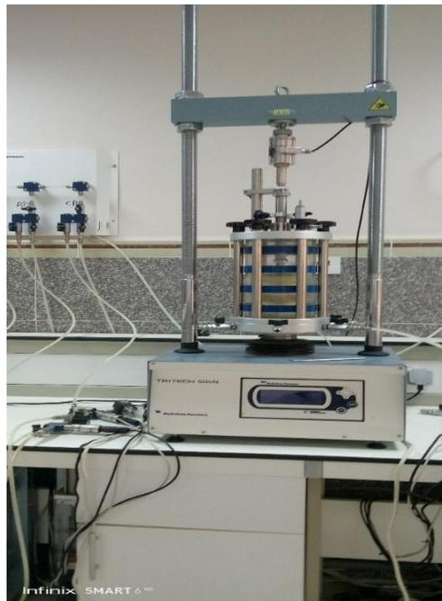
**Figure 2-37 :** Machine de triaxiale.
