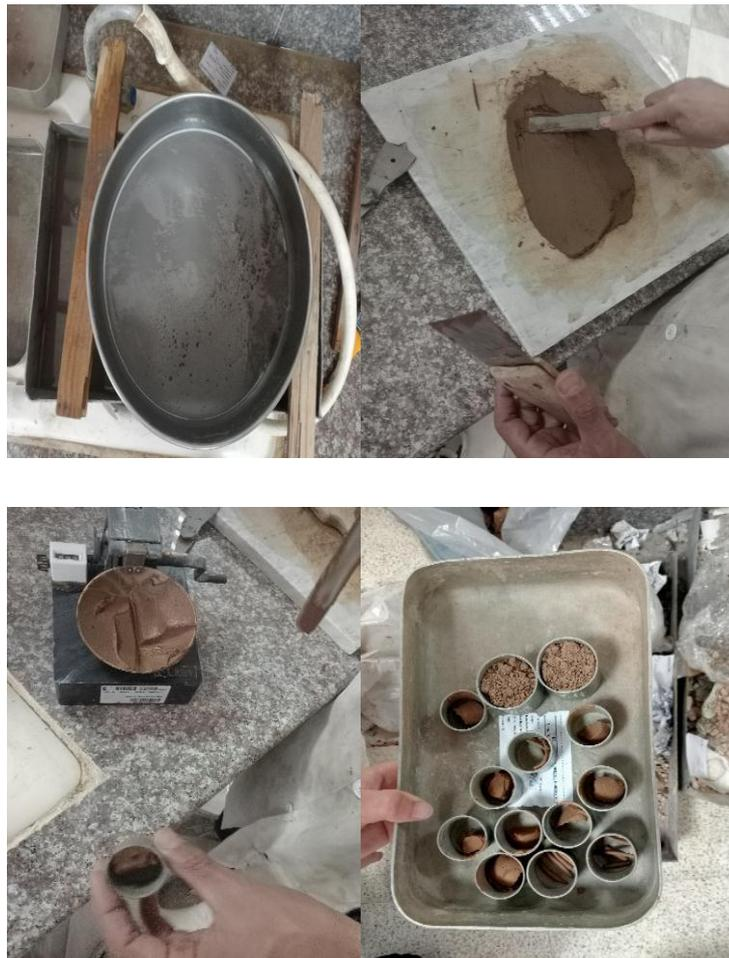
Figure2-10 : les étapes de l'essai des limites
