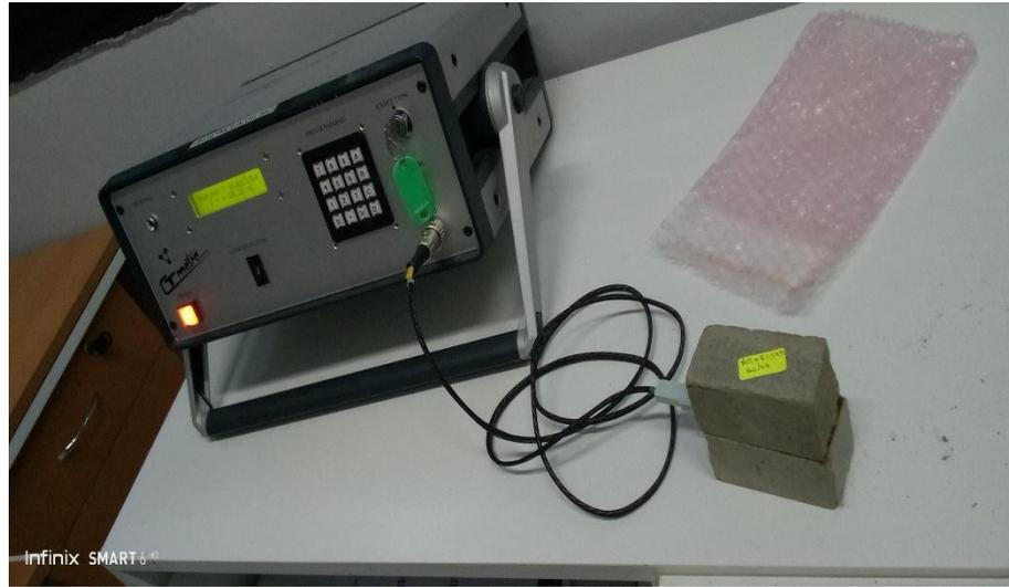
**Figure 2-46 :** Effectuer l'opération de la conductivité thermique.
