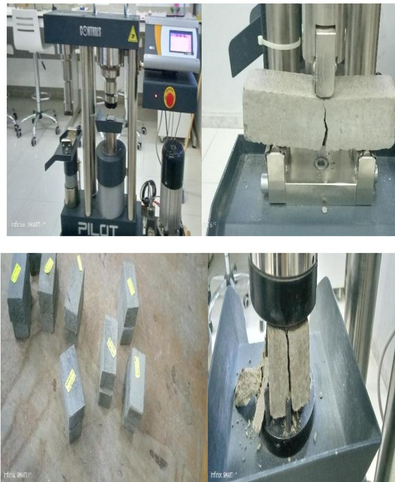
**Figure 2-43** : les étapes de l'essai flexion et de compression
