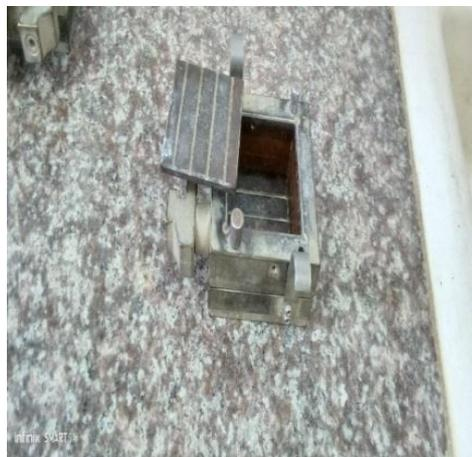
**Figure 2-30 :** Machine De Cisaillement. **Figure 2-31 :** la boîte de cisaillement.
