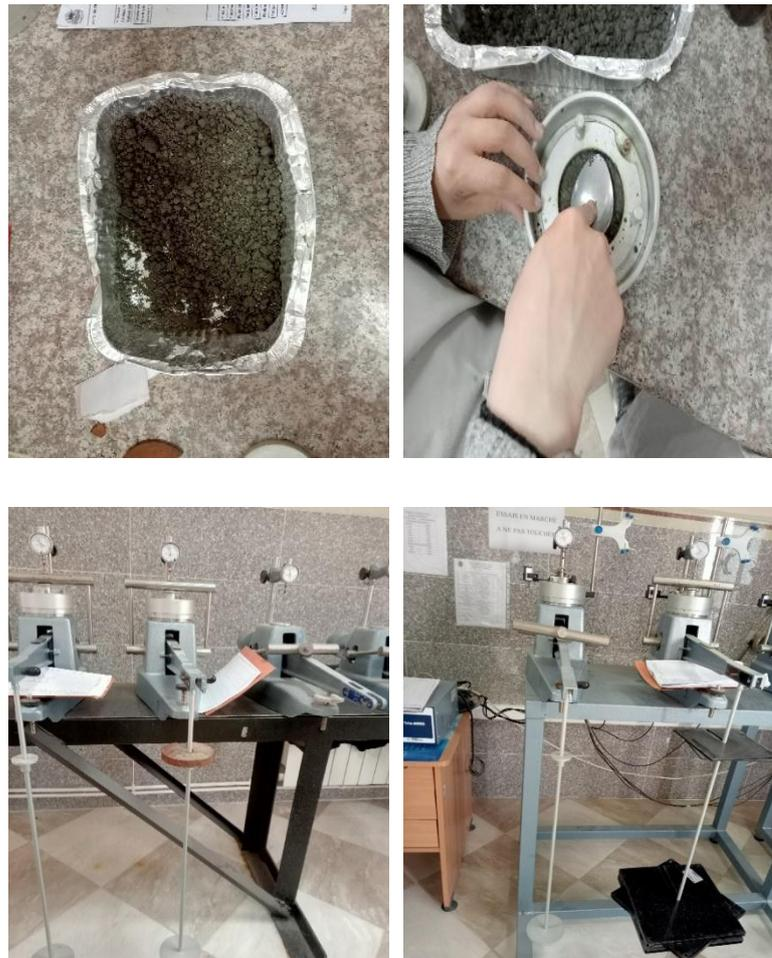
Figure 2-36 : Les étapes de l'essai odomètre.
