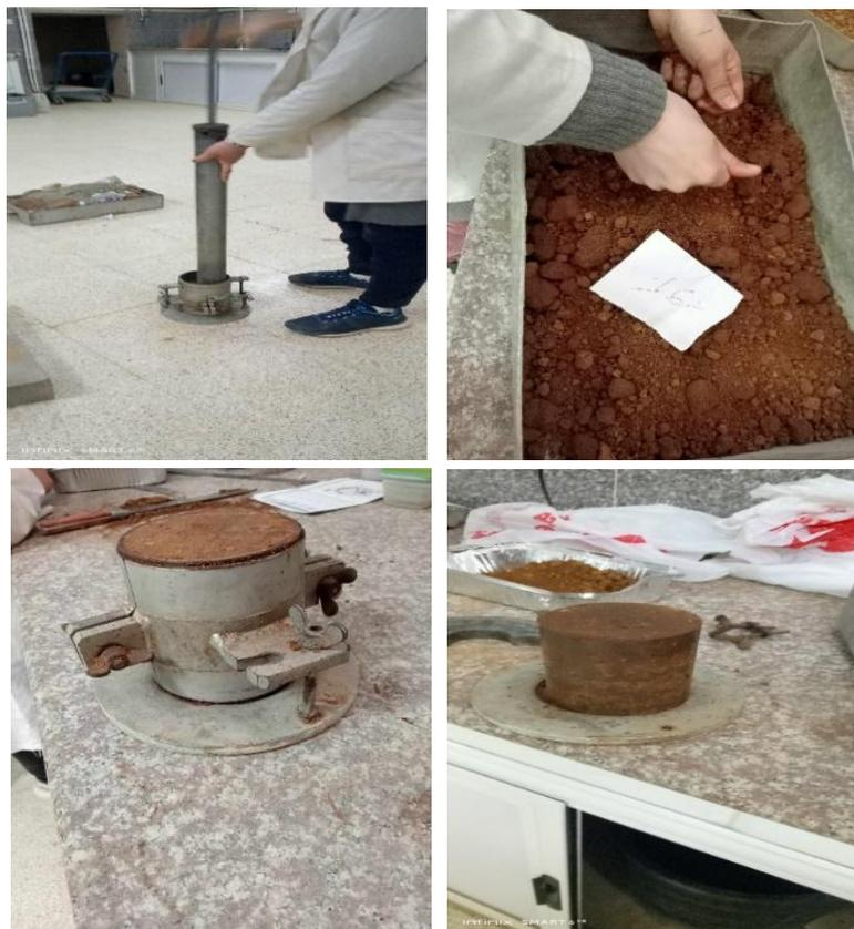
**Figure 2-29** : les étapes de l'essai Proctor.
