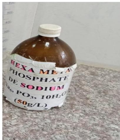
**Figure 2-16 :** dé flocculant (solution hexa méta
