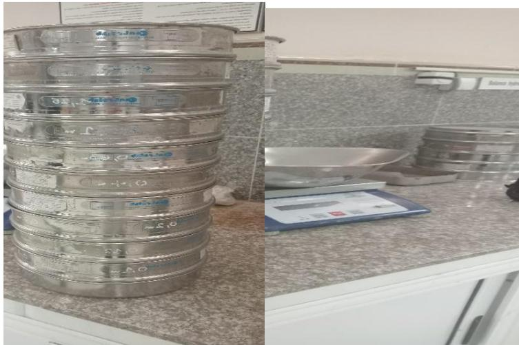
**Figure 2-13 :** Les Etapes de l'essai granulométrique.
