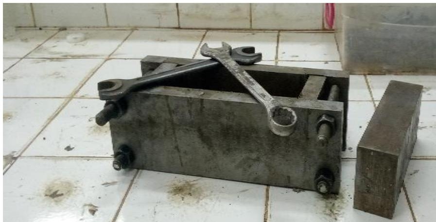
**Figure 2-41 :** Moules prismatiques (40×40×160) mm<sup>3</sup>
