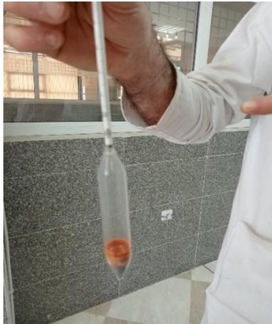
**Figure 2-14 :** un densimètre gradué.
