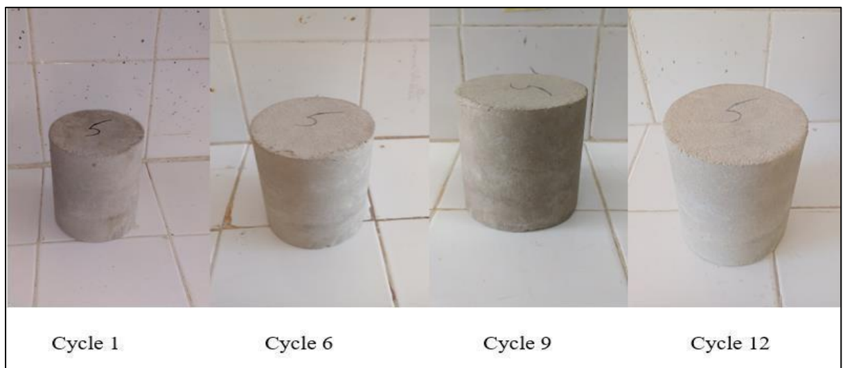
Figure III-15 : L'évolution de la dégradation de l'échantillon
