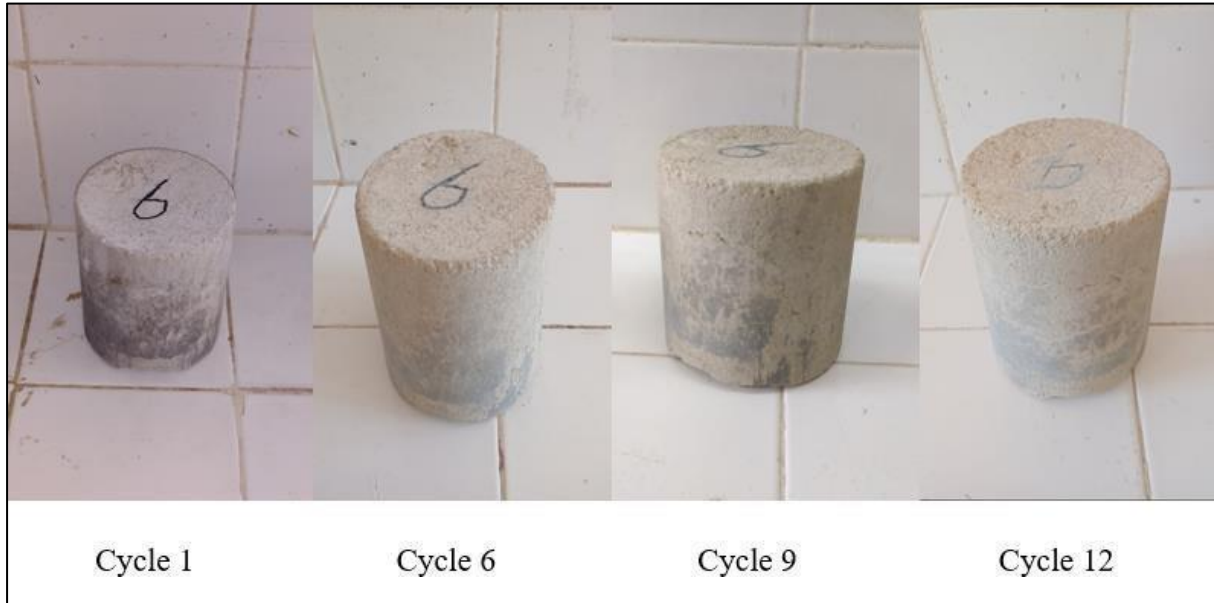
Figure III-16 : L'évolution de la dégradation de l'échantillon
