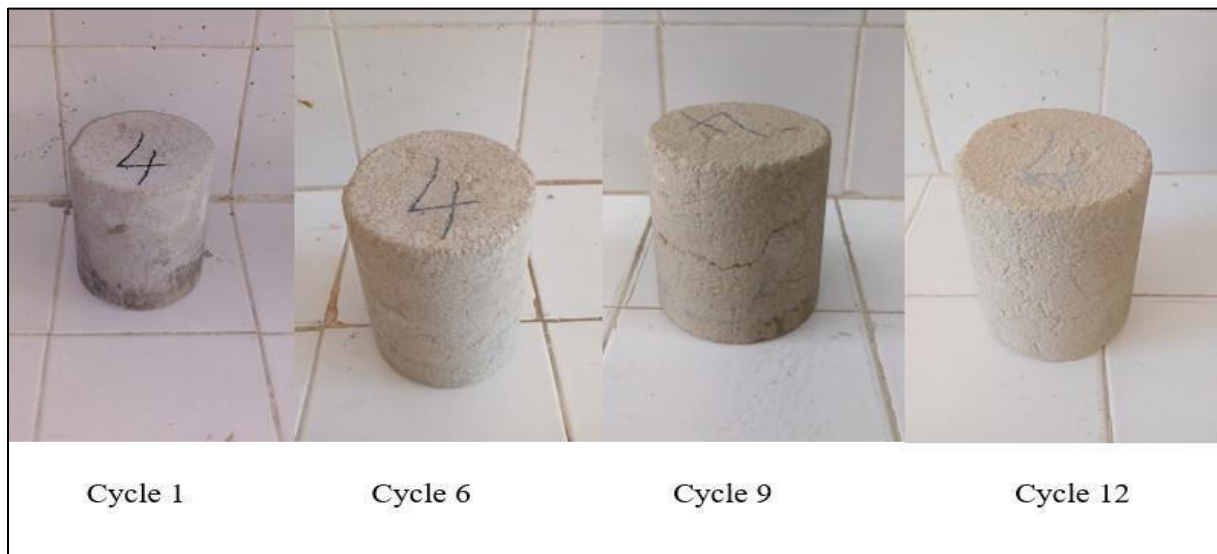
Figure III-14 : L'évolution de la dégradation de l'échantillon.
