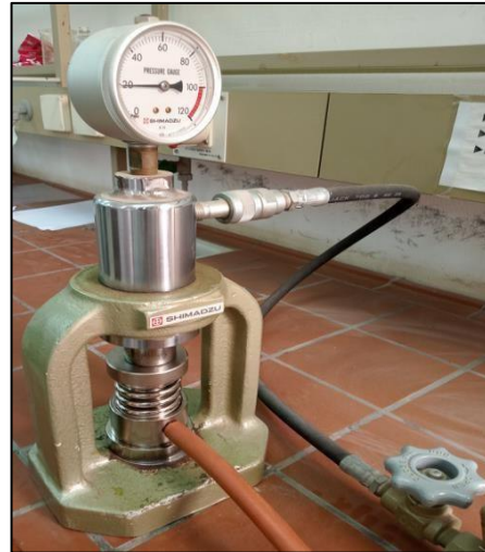
Figure II-26 : Compactage de la pastille
