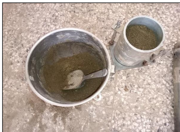
Figure II-17 : Mise en place du matériau dans le moule
