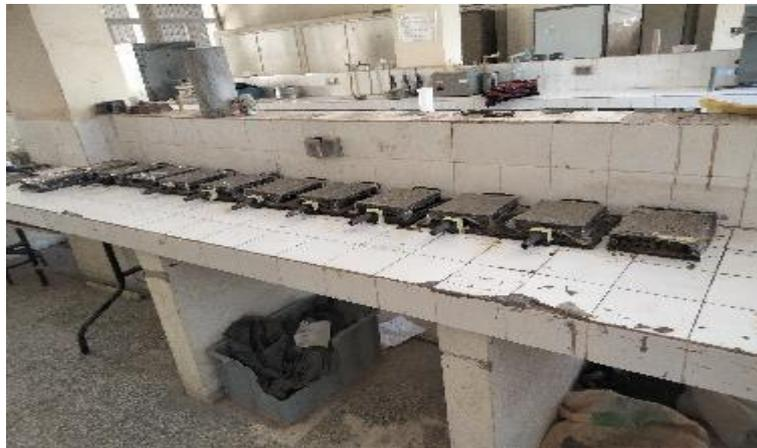
Figure III.4 : Éprouvettes recouverts d'un film plastique
