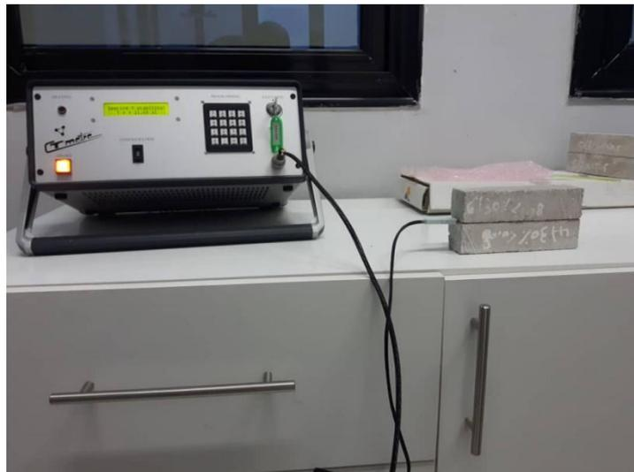
Figure III.20 : Essai de la conductivité thermique
