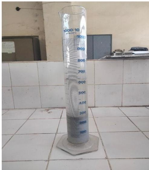
**Figure II.13: L'essai de masse volumique absolue du verre trempé.**
