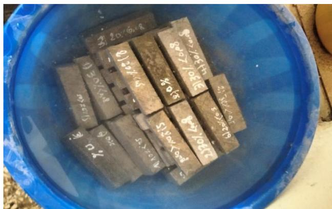
Figure III.5 : Conservation des éprouvettes dans l'eau.
