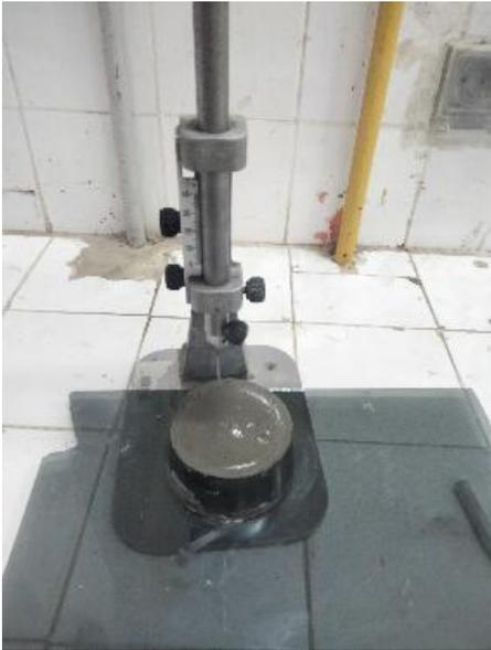
Figure II.11: Essai de prise de ciment.
