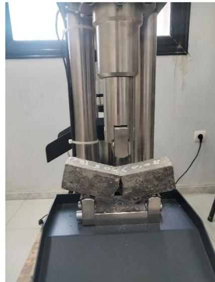
Figure III.15 Rupture de l'éprouvette.
