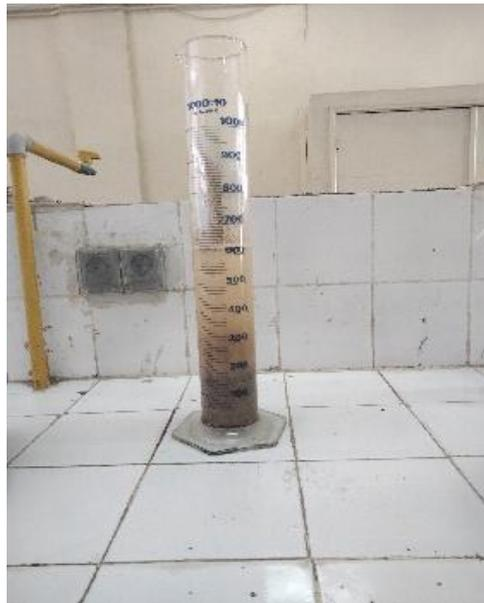
**Figure II.6 : Éprouvette d'essai de la masse volumique de sable carrier.**
