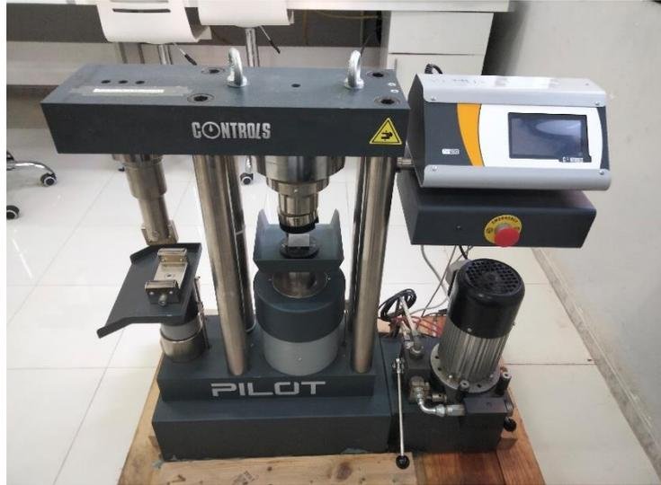
Figure III.13: Le dispositif d'essais de compression et de flexion.
