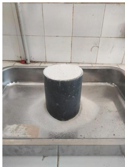
Figure II.14 Essai de la masse volumique apparente.
