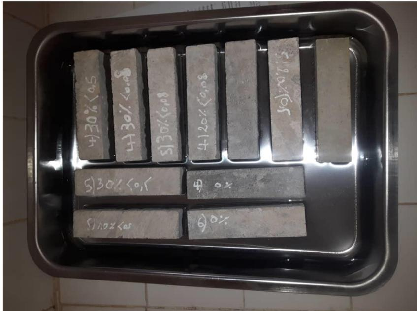
Figure III.10 : Essai d'absorption capillaire
