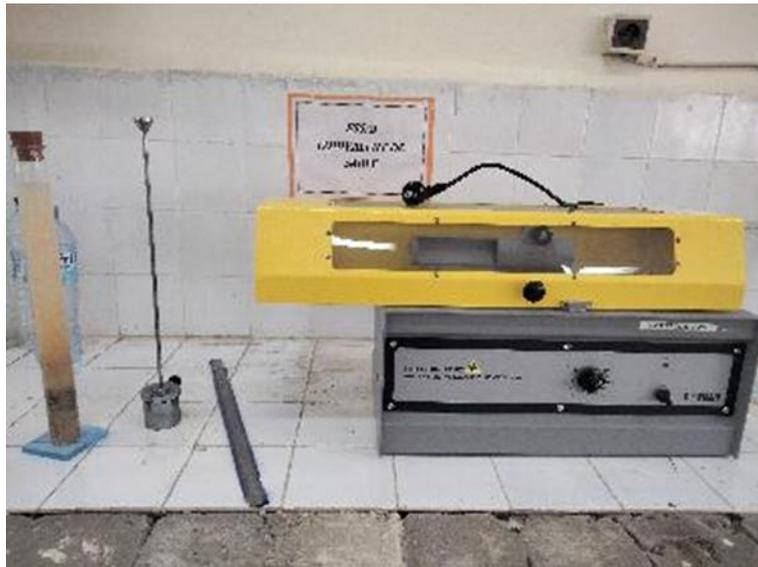
Figure II.9 : Matériel utilisé pour l'équivalent de sable.
