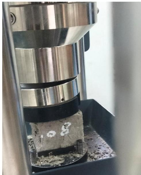
**Figure III.17 : Essai de compression pour la demi-prisme.**
