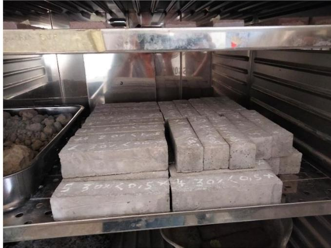
Figure III.8 : Étuvage des éprouvettes.
