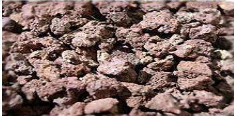
Figure I.3 : Pouzzolane artificielle. [19]
