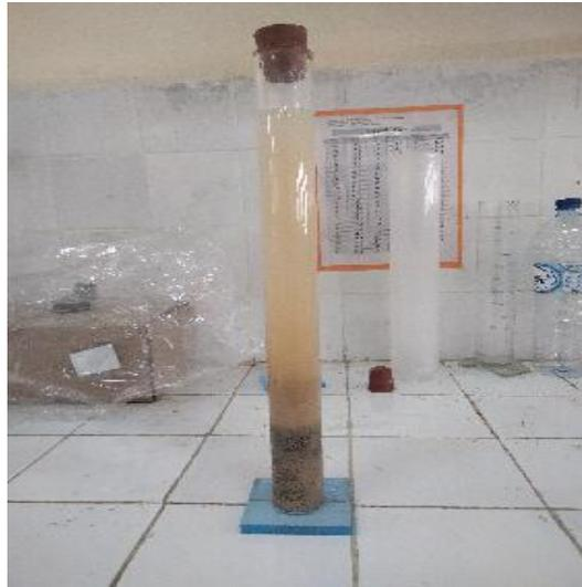
Figure II.10 : L'éprouvette préparée pour l'essai d'équivalent de sable.
