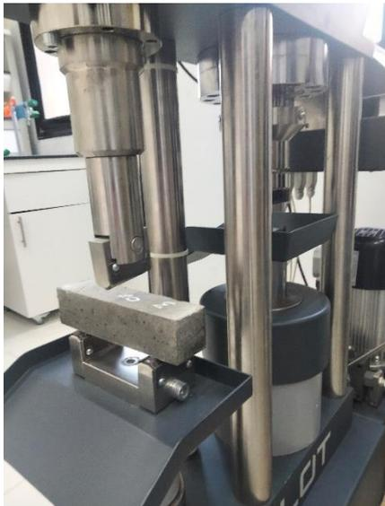
Figure III.14 : Mise en place de l'éprouvette.
