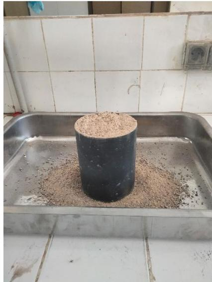
**Figure II.7 : L'essai de la masse volumique apparente.**
