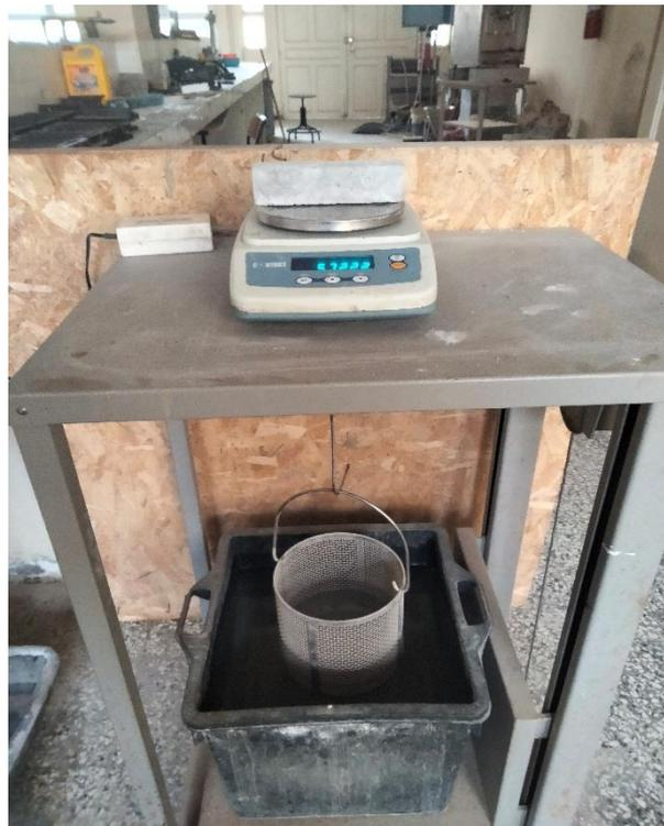
Figure III.6 : Essai de porosité.
