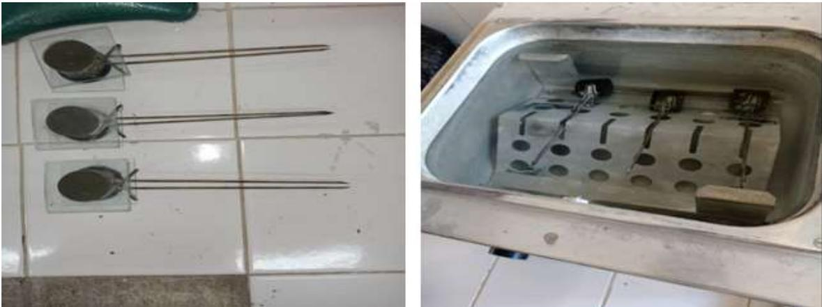
**Figure II.7 :** Echantillons de ciment testé en expansion le Chatelier.
