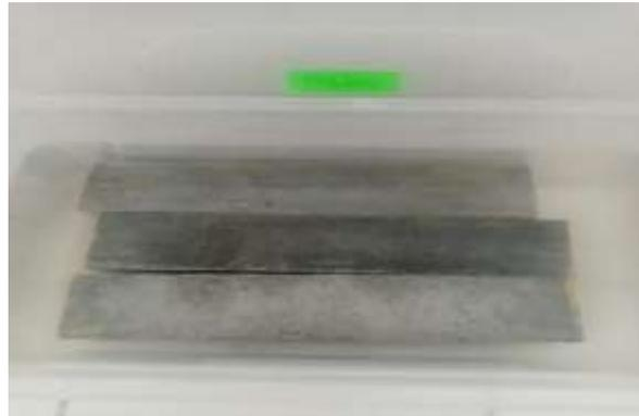
**Figure III.10 :** Conservations des éprouvettes dans la solution de sulfates de magnésium
