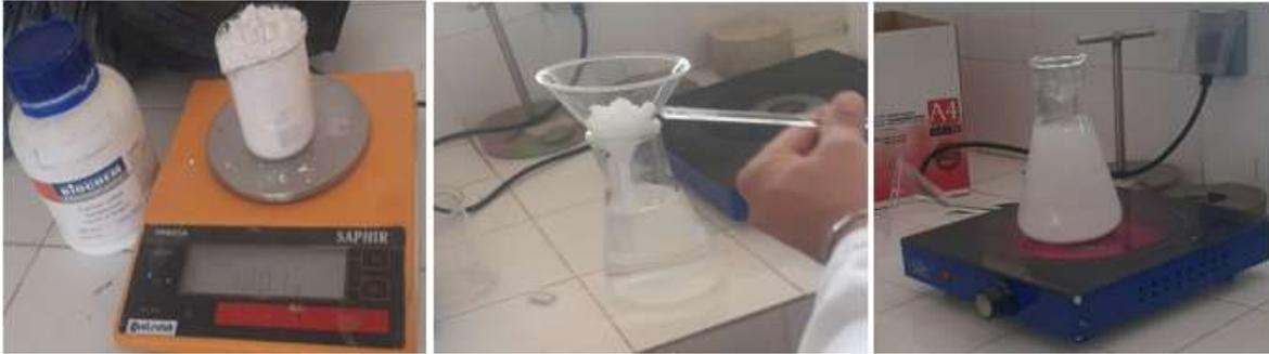
**Figure III.11 :** Etapes de préparation de la solution de 5% de sulfates de calcium
