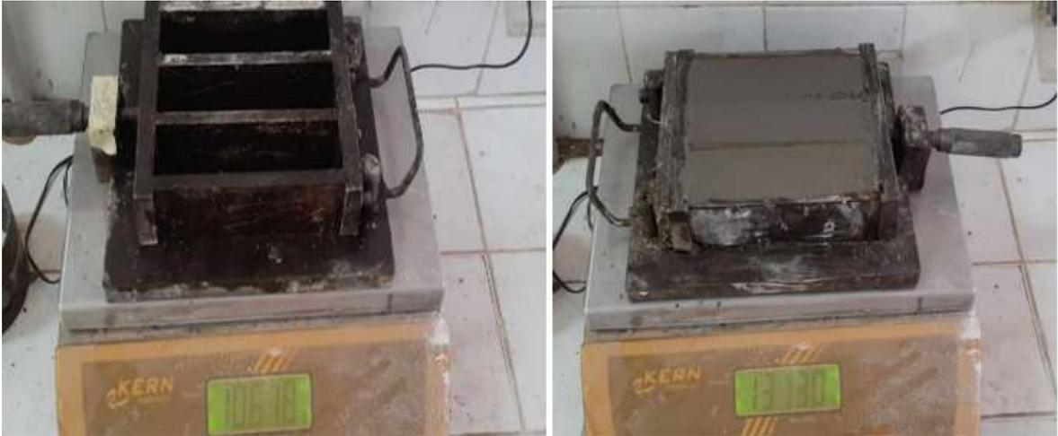
**Figure III.3 :** Les pesées des moules vides et pleins
