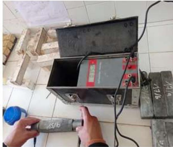
**Figure III.20 :** Mesure du temps de propagation des ondes d'un prisme de mortier de 160mm de longueur.
