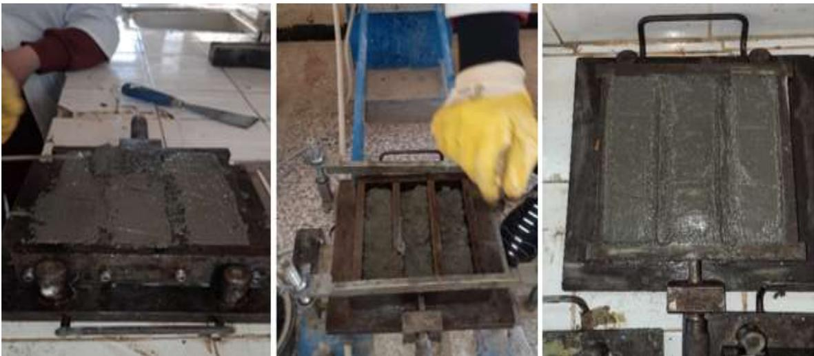
**Figure III.4 :** La mise en place des mortiers confectionnés.
