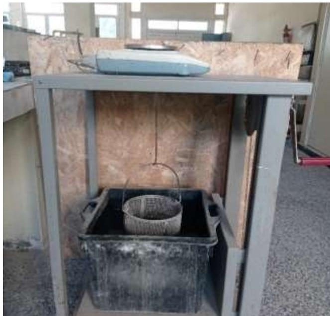
Figure III.26 : Principe de mesure de la poussée d'Archimède
