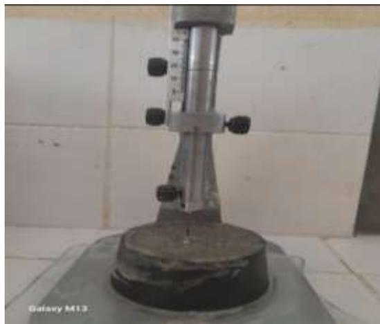
**Figure II.6 :** Appareil de Vicat muni de sa sonde de consistance
