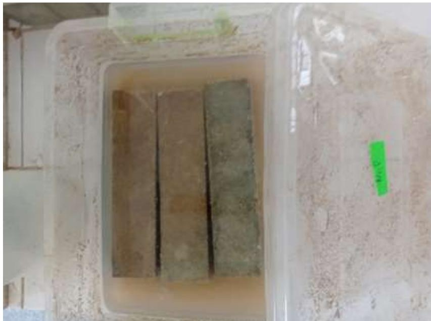
**Figure III.14 :** Conservation des éprouvettes dans la solution de 5% d'acide chlorhydrique
