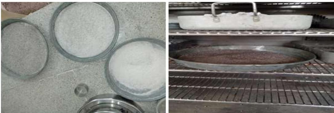
**Figure II.14 :** Détermination de la teneur en eau pondérale des matériaux
