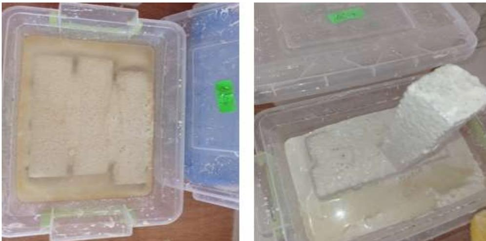
**Figure IV.23 :** Epreuves attaqués par l'acide sulfurique (H<sub>2</sub>SO<sub>4</sub>)
