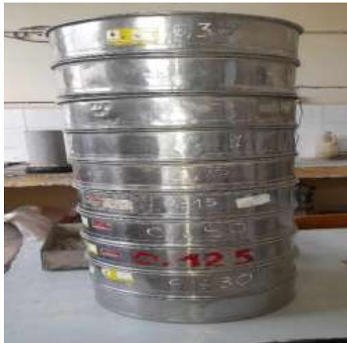
**Figure II.10** : La série des tamis utilisée
