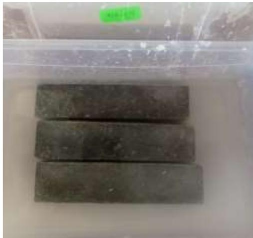
**Figure IV.21 :** Eprouvettes attaquées par les sulfates de sodium ( $\text{Na}_2\text{SO}_4$ )
