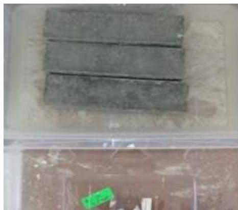
**Figure IV.26 :** Epreuves conservées dans l'eau de robinet
