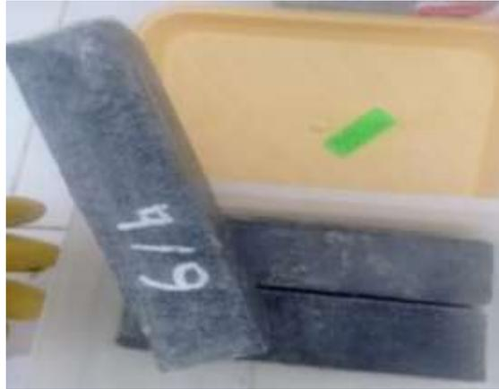
**Figure III.17 :** Conservation des éprouvettes dans l'eau distillée
