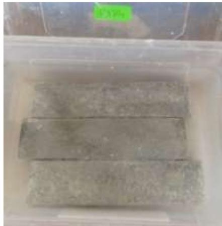
**Figure IV.24 :** Echantillons de mortier attaqués par du sulfate de magnésium ( $MgSO_4$ )
