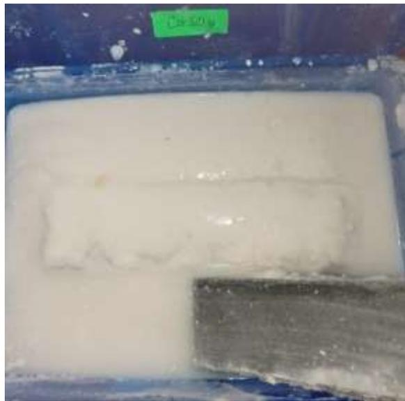
**Figure IV.27 :** Echantillons de mortier attaqués par les sulfates de calcium ( $\text{CaSO}_4$ )
