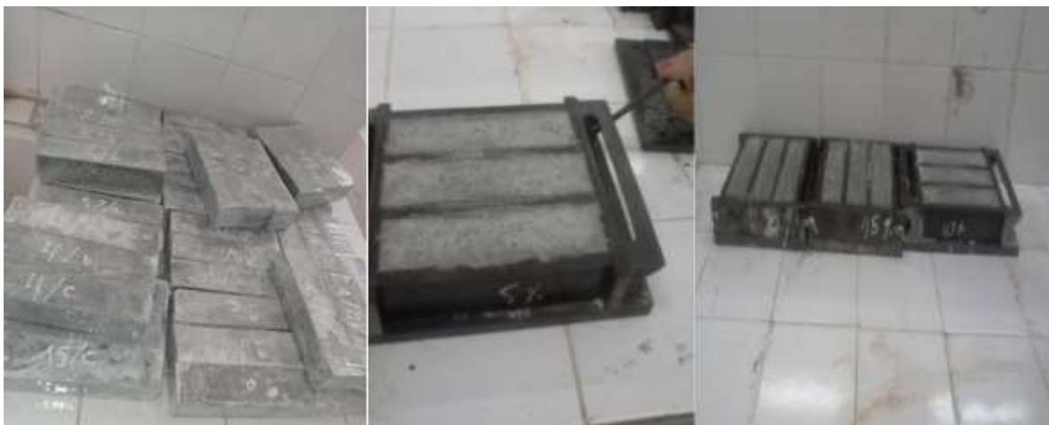
**Figure III.5 :** Démoulage des éprouvettes
