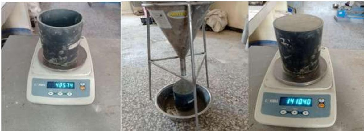
**Figure II.4 :** Mesure de la masse volumique apparente du ciment
