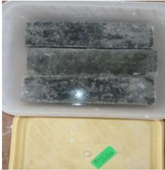
**Figure IV.25 :** Epreuve attaqué par l'eau distillé
