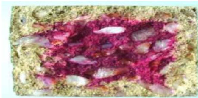
**Figure I.6 :** Carbonatation d'un béton
