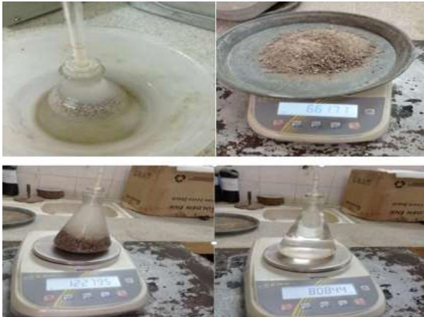
**Figure II.12 :** Etapes de calcul de la masse volumique réelle et la détermination de coefficient d'absorption d'eau du sable selon la norme NF EN 1097-6.
