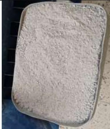
**Figure II.8 :** Le sable de carrière utilisé
