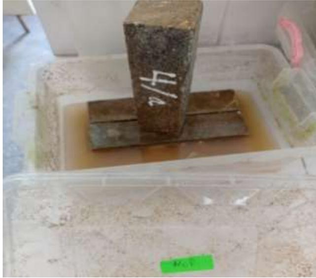
**Figure IV.22 :** Epreuves attaqué par l'acide chlorhydrique (HCl)
