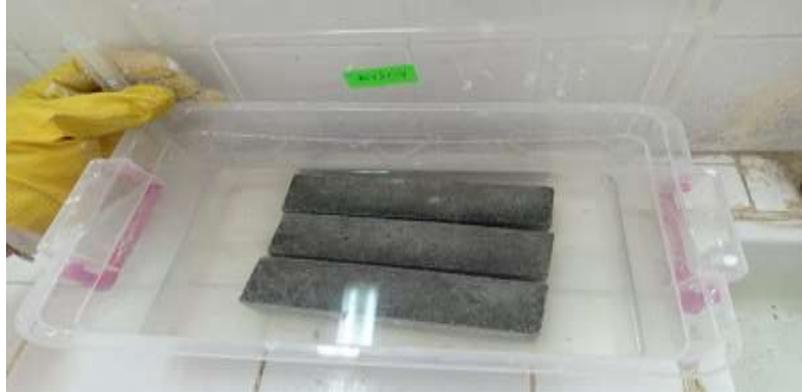
**Figure III.8 :** Conservations des éprouvettes dans la solution de sulfates de sodium
