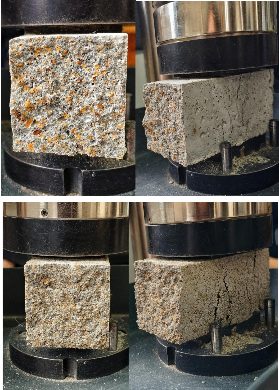
Figure III.7 : Ecrasement de deux demi échantillons sous l'effet de la compression.
