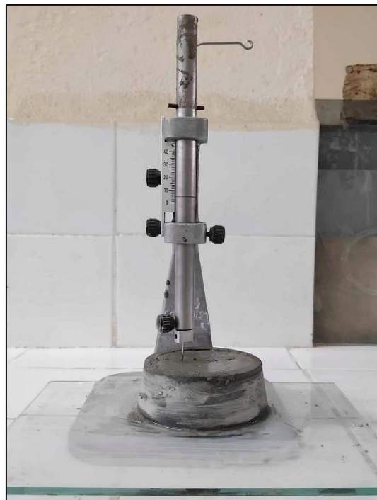
Figure.II.12 : Essai de consistance par l'appareil de Vicat.
