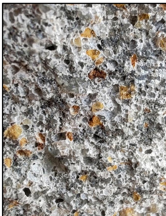
Figure III.13 : Mortier de liège de 0.5 mm
