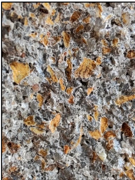
Figure III.12 : Mortier de liège de 1.5mm
