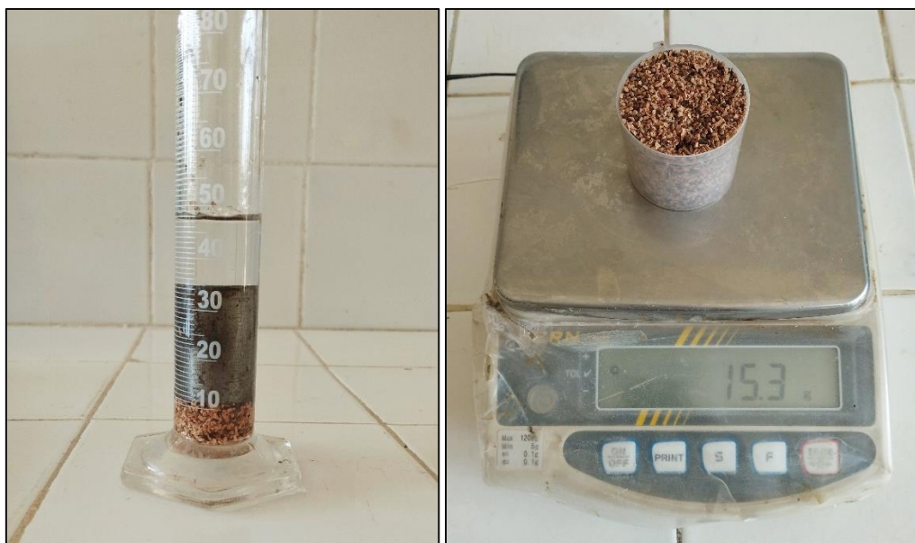
Figure II.6 : Mesure de la masse volumique absolue et apparente.
