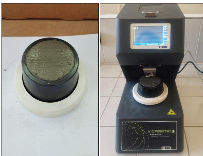
Figure.II.13 : Essai de prise avec l'appareil de Vicat automatique
