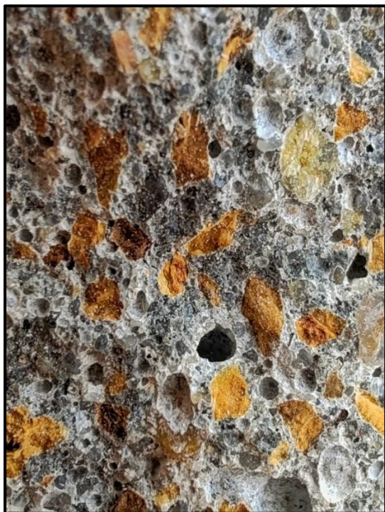
Figure III.11 : Mortier de liège de 2mm
