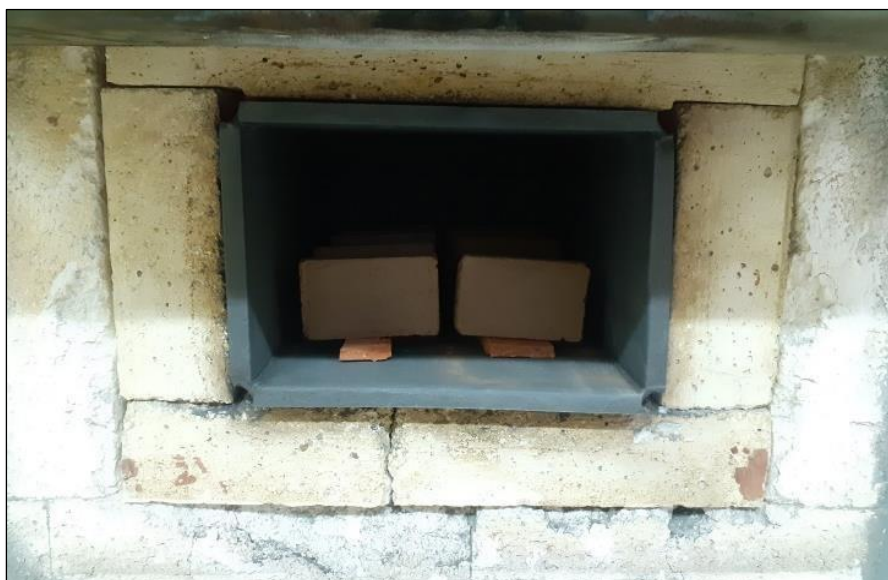
Figure II.34 : La cuisson des briques dans un four électrique
