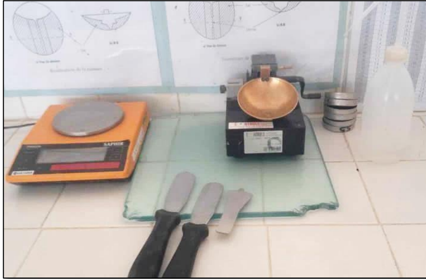
Figure II.19 : Appareil de Casa grande, spatule, tares et outils à rainure
