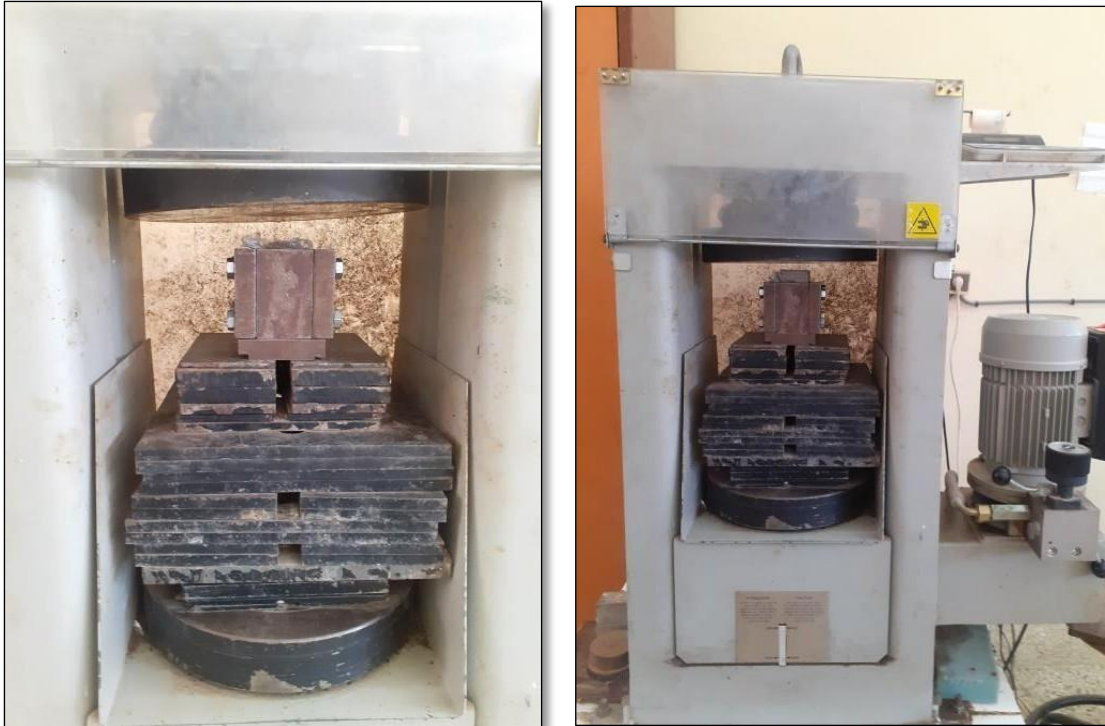
Figure II.31 : Pressage des éprouvettes
