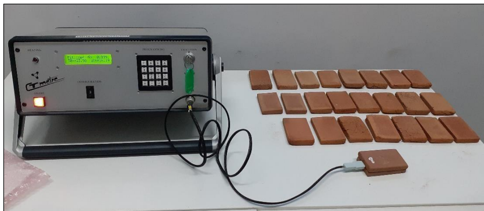
Figure II.44 : Détermination de la conductivité thermique des briques (marc du café)
