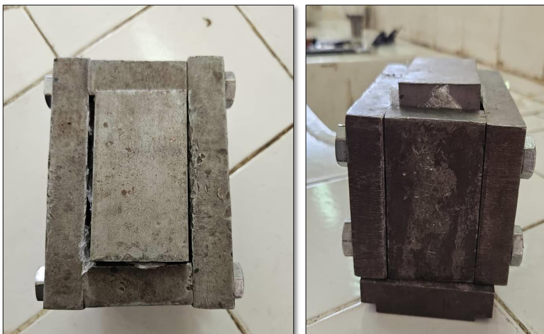
Figure II.30 : Remplissage du moule
