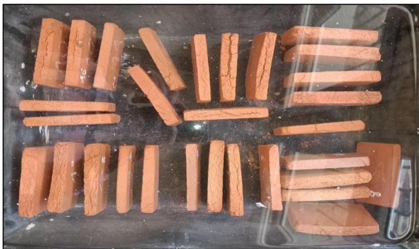
Figure II.37 : Briques (marc du café) immergées
