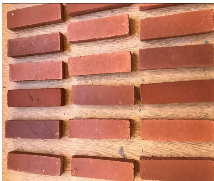
Figure II.28 : La brique à la sortie du four
