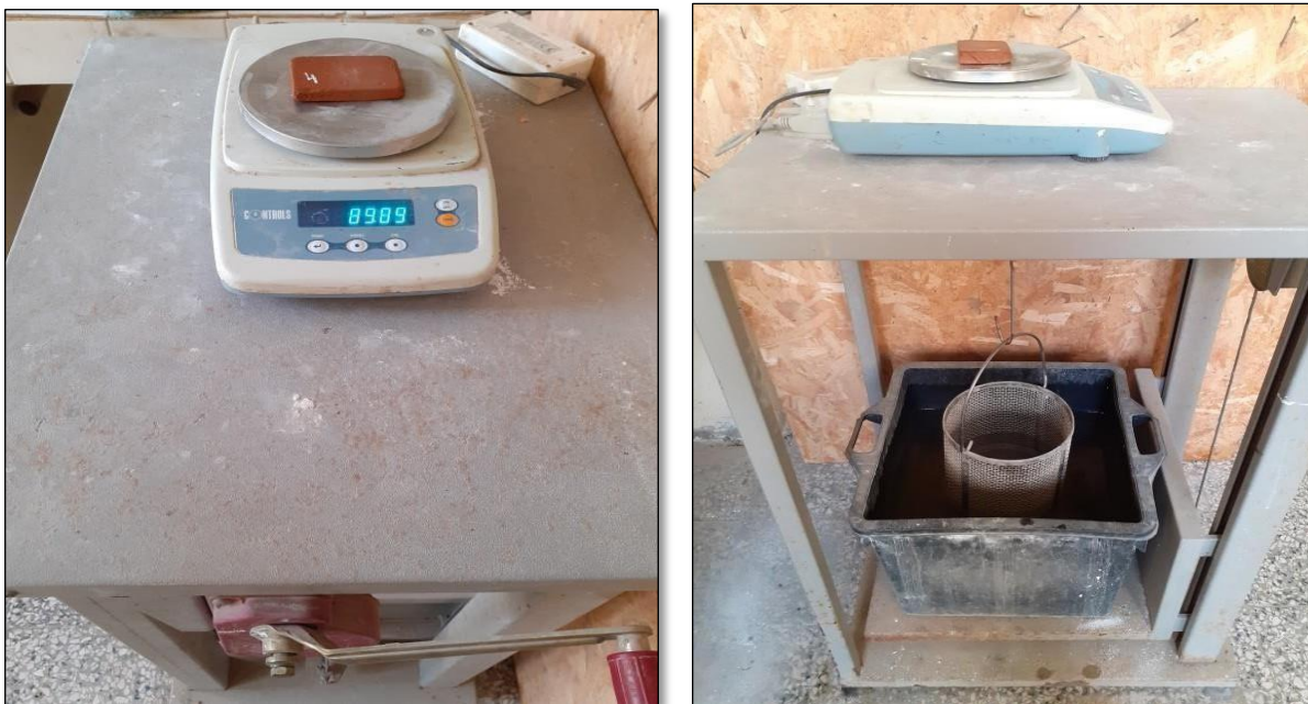
Figure II.39 : Détermination de la masse saturée d'eau des briques avec ajout marc du café
