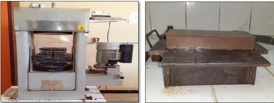
Figure II.26 : Pressage des éprouvettes et moulage des briques
