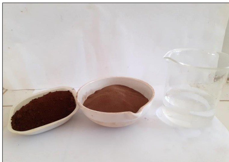
Figure II.29 : Mélange (argile + marc de café+ eau)
