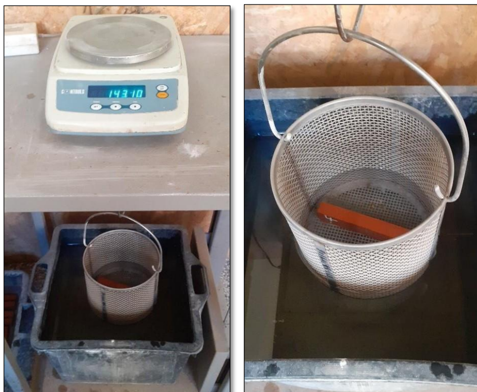
Figure II.40 : Pesée hydrostatique des briques avec ajout de sugar scum
