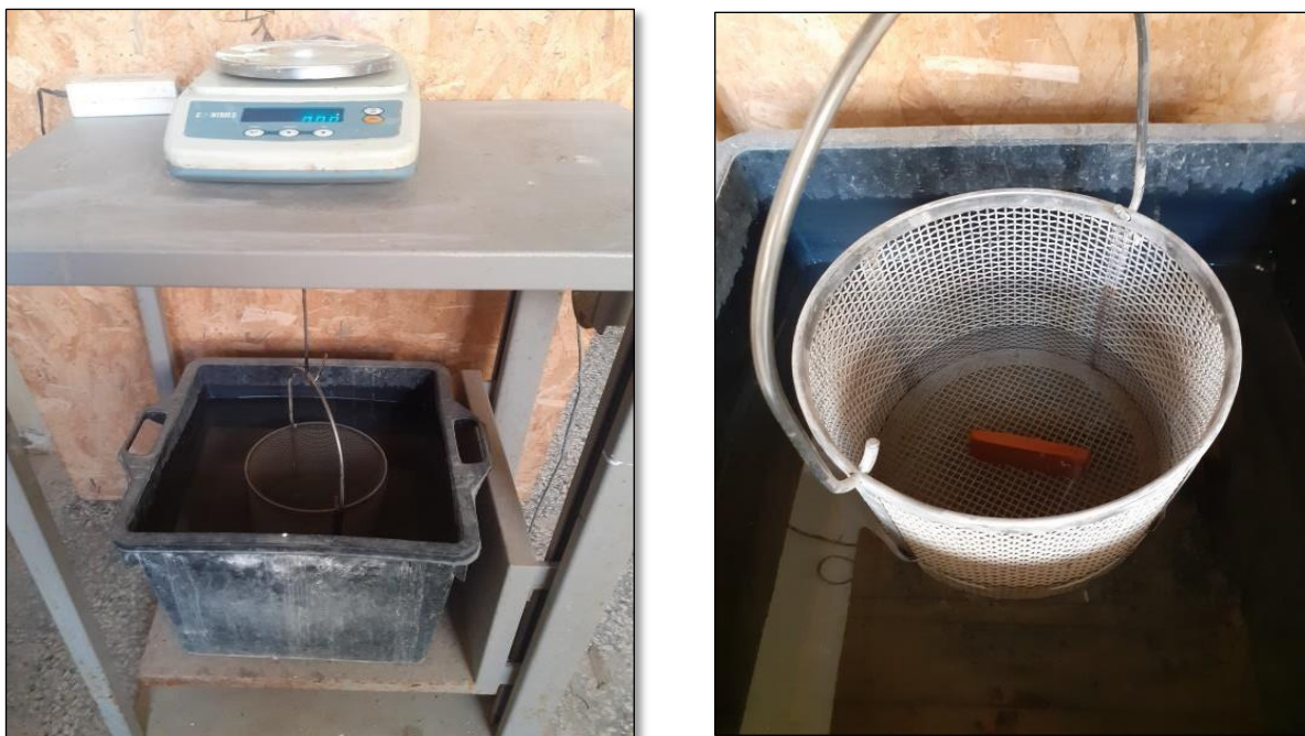
Figure II.41 : Pesée hydrostatique des briques avec ajout du marc du café
