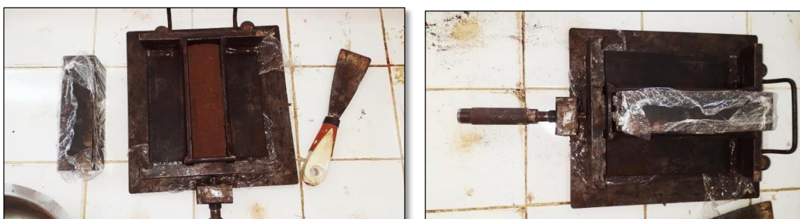
Figure II.25 : Remplissage du moule
