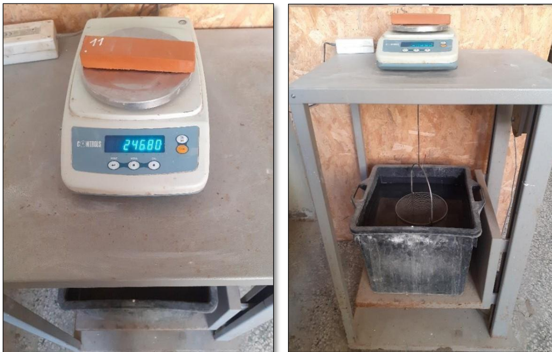
Figure II.38 : Détermination de la masse saturée d'eau des briques avec ajout de sugar scum
