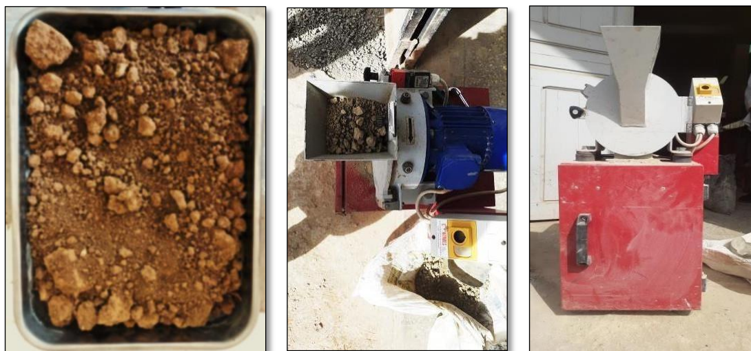
Figure II.21 : Broyage de la matière première à l'aide d'un broyeur
