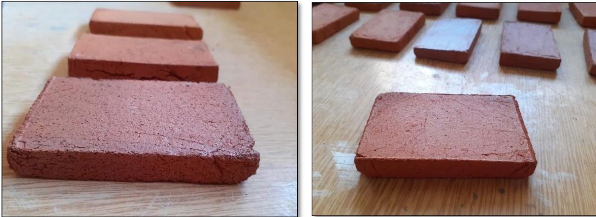
Figure II.35 : La brique à la sortie du four
