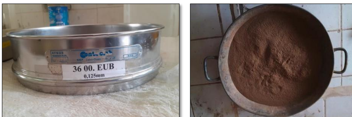
Figure II.22 : Tamisage de la matière première (argile)
