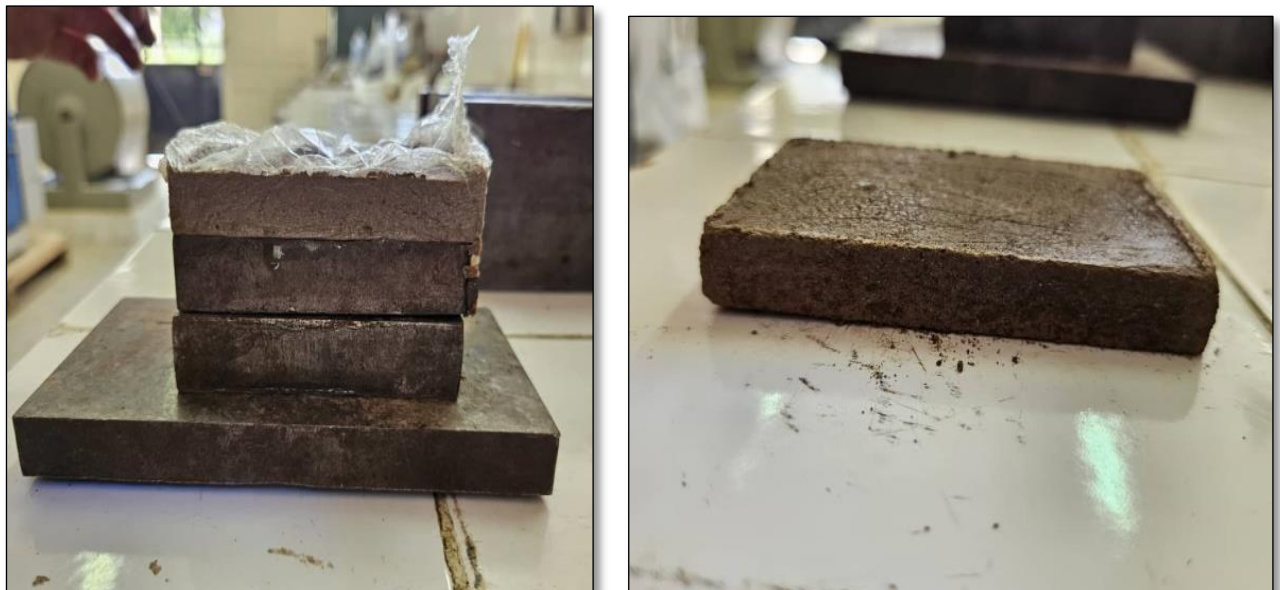
Figure II.32 : Démoulage des briques
