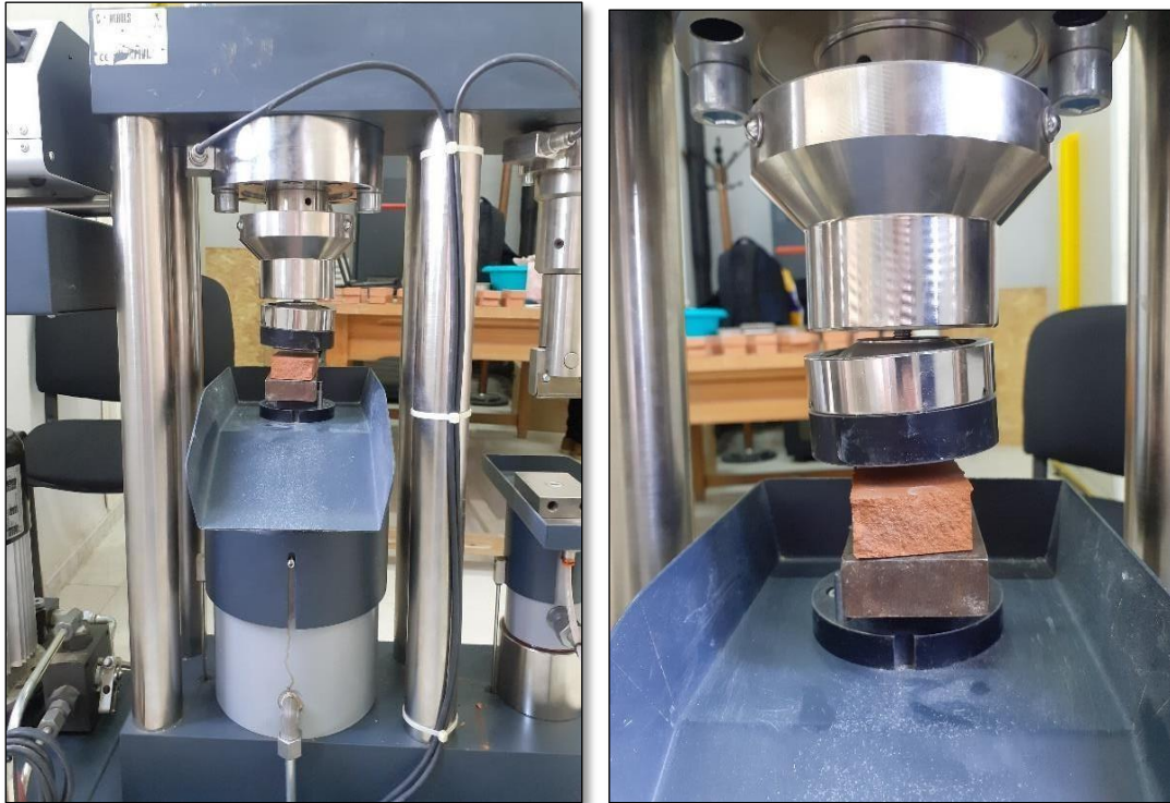
Figure II.48 : Appareil de la résistance à la compression (laboratoire génie civil université Bejaia)
