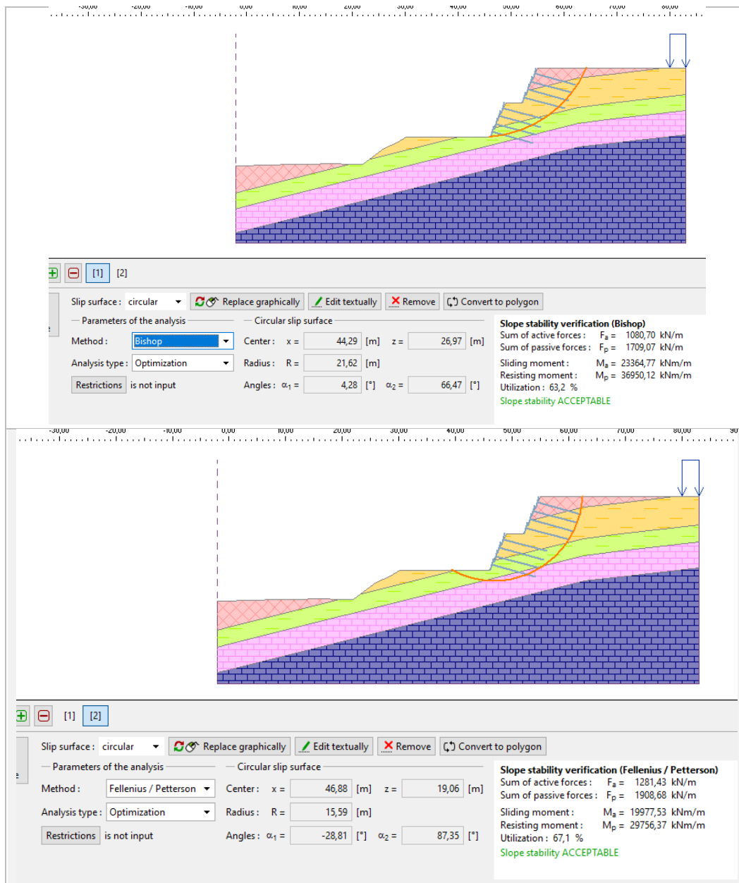
Figure V.9 Résultats de Calcul de Stabilité du talus après talutage et augmentation de longueur des clous
