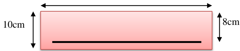
Fig.III.22 : Section à ferrailer.
