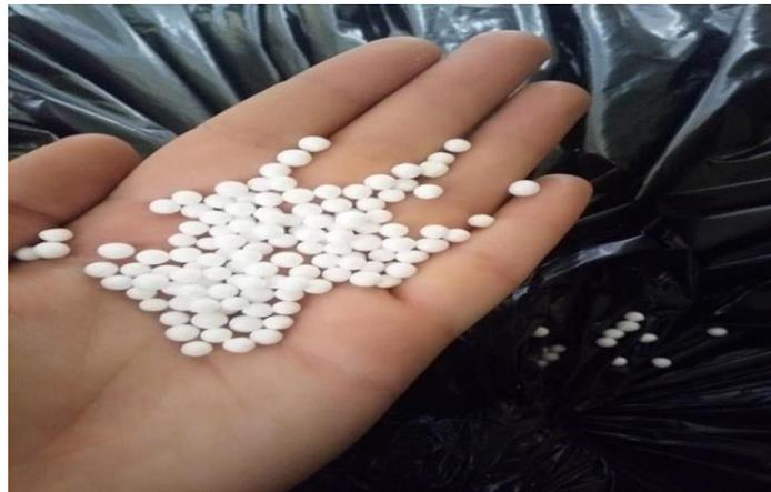
**Figure I.7.** Polystyrène expansé
