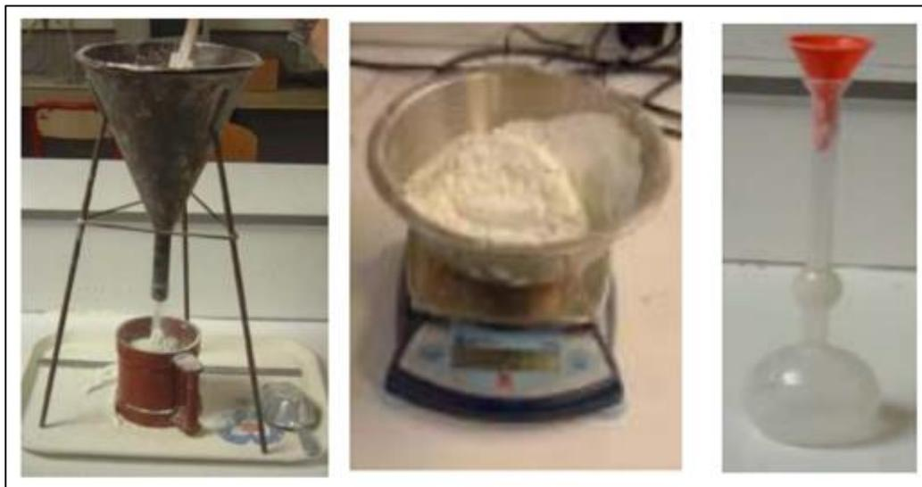
**Figure II. 1.** Détermination de la masse volumique apparente d'un matériau
