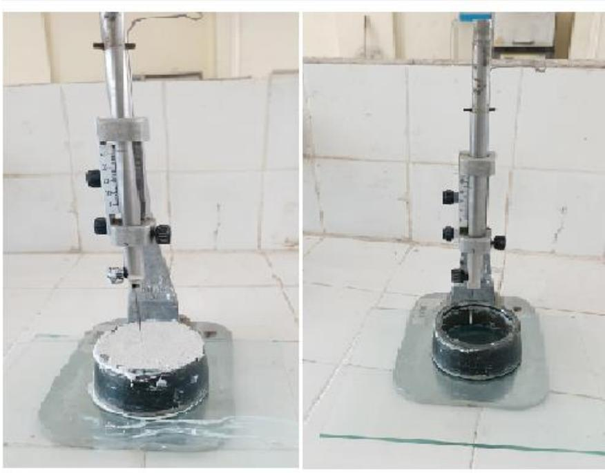
Figure II.5. L'appareil de Vicat
