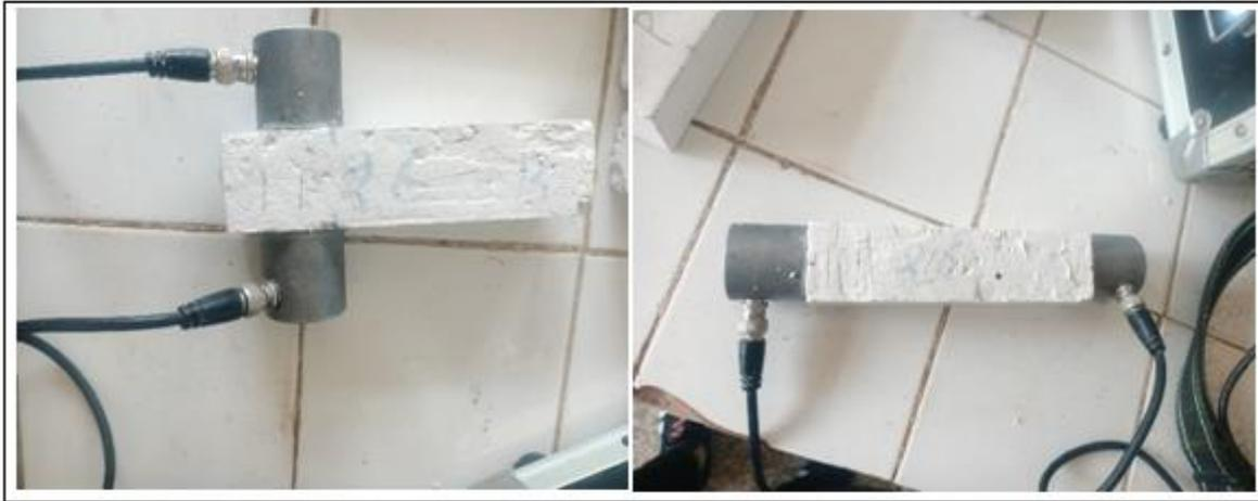
**Figure II.14.** Mesure par la méthode ultrason
