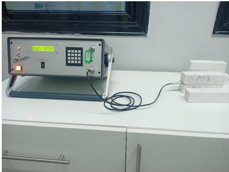
Figure III.8.essai de condivite thermique
