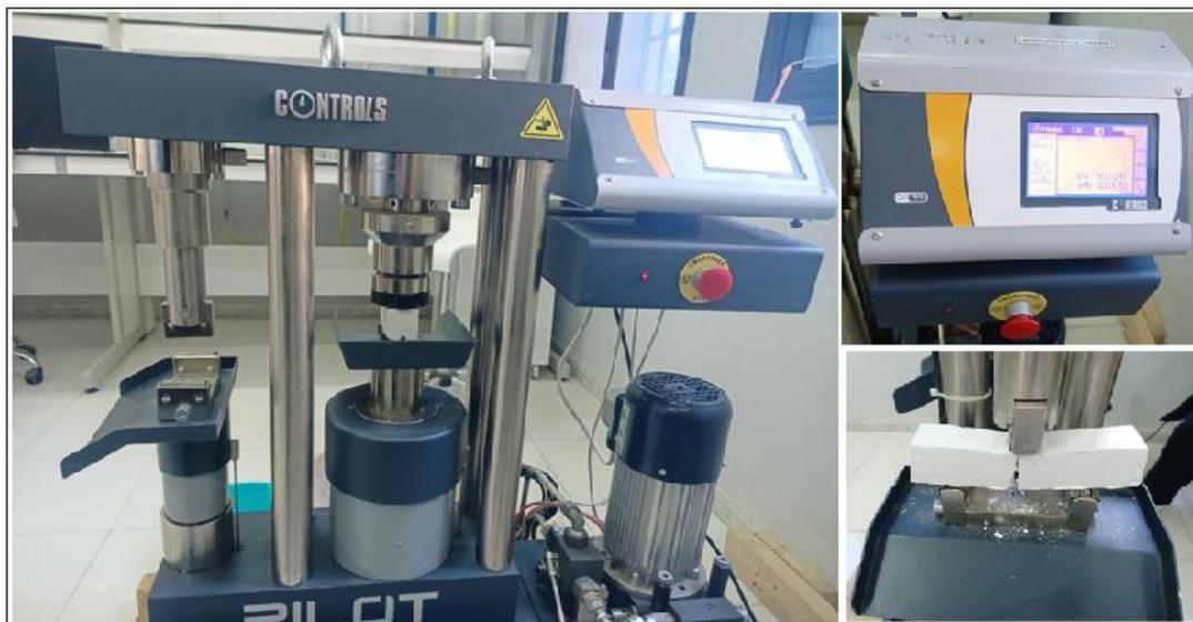
**Figure II.15.** La machine pour essais de flexion
