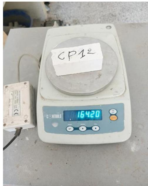
**figure II.11.** Pesé hydrostatique à l'état saturé
