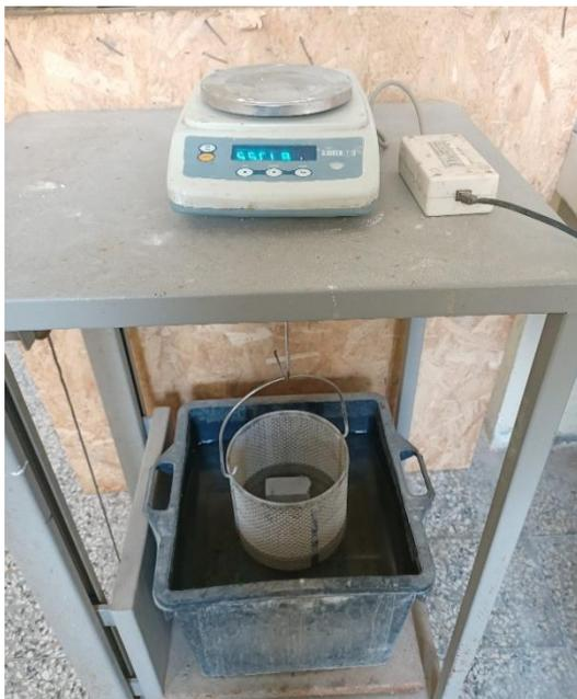
**Figure II.10.** Pesé hydrostatique sous l'eau
