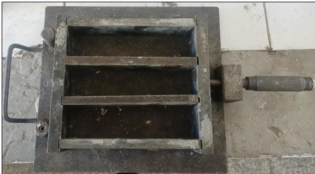
**Figure II.8.** Des moules prismatique  $(4 \times 4 \times 16)$  cm<sup>3</sup>
