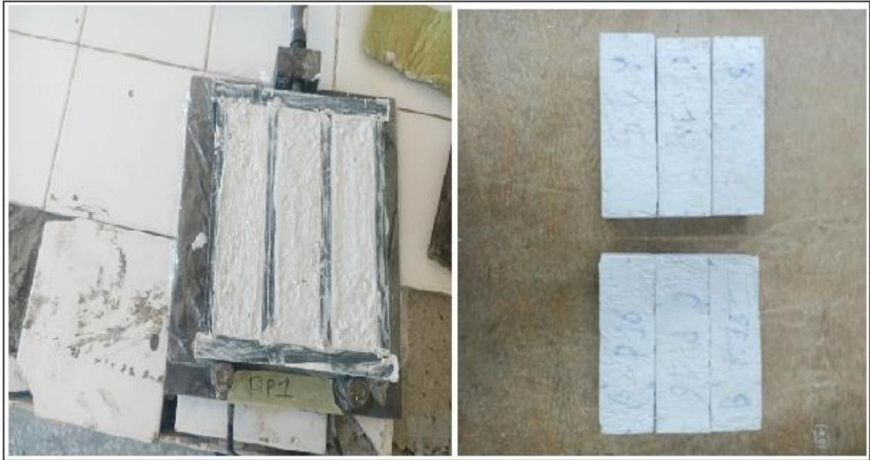
**Figure II.9.**Les éprouvette prismatique (4x4x16) cm<sup>3</sup>
