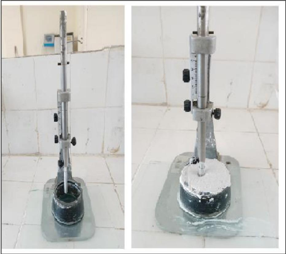
Figure II. 3. Appareil de Vicat muni de l'aiguille avec une surcharge
