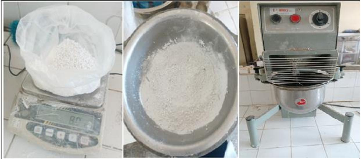
**Figure II.7.** pesé du plâtre et polystyrène et Le Malaxage
