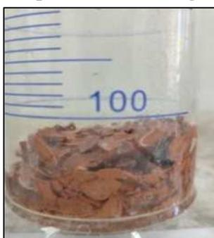
Figure II.15 : Sol avec solution ( $\text{Na}_6(\text{PO}_3)_6 \cdot 10\text{H}_2\text{O}$ )
