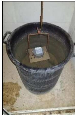
Figure II.4 : Pesage en suspension dans l'eau
