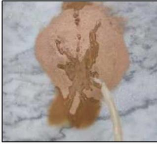
Figures II.27 : Mouillage de l'échantillon sec
