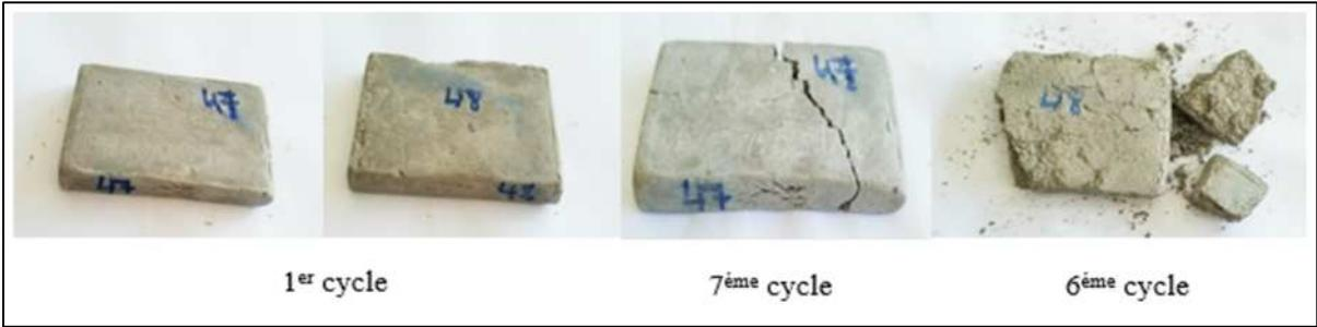
Figure IV.12 : dégradation des briques de l'échantillon d'Oued soummam+8% ciment
