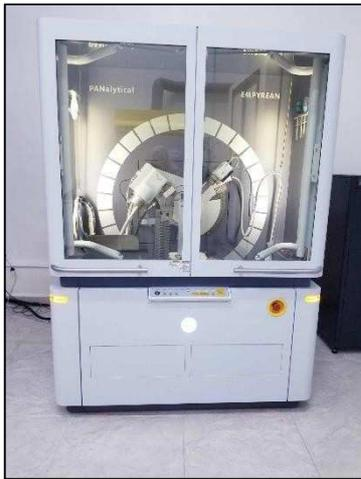
Figure II.60 : appareil d'analyse de DRX
