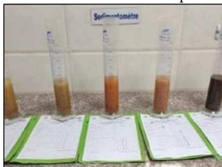
Figure II.16 : Mise en repos de l'échantillon
