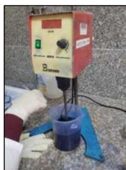
Figure II.45 : Prélèvement par baguette de verre
