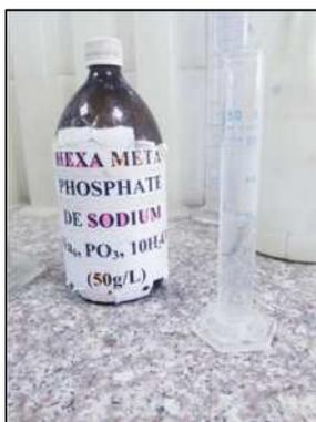
Figure II.14 : défloculant d'hexamétaphosphate de sodium
