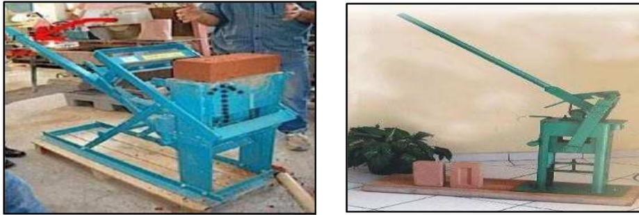
Figure (I.19) (I.20) : Brique de terre crue compressée réalisée à l'aide d'une presse manuelle
