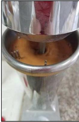
Figure II.17 : Agitation de l'échantillon
