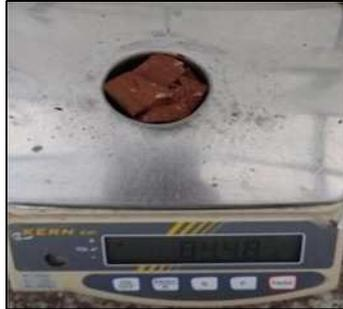
Figure II.1 : Pesée du sol humide
