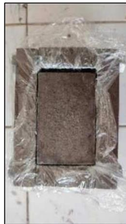
Figure II.49 : Moule de brique
