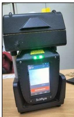
Figure II.56 : Appareil utilisé pour la FRX
