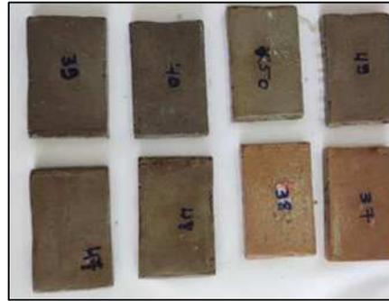
Figure II.64 : Briques après humidification
