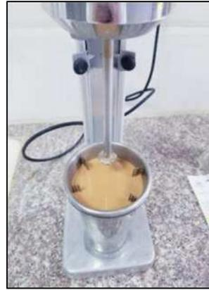
Figure II.18 : Agitateur mécanique
