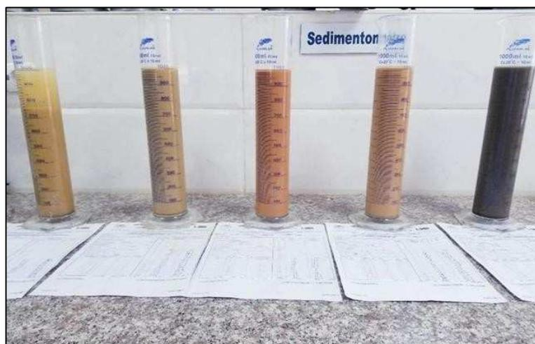
Figure II.21 : Mise en suspension différents échantillons pour la mesure de sédimentométrie
