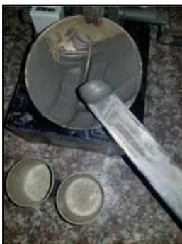
Figure II.33 : Prélèvement de pâte aux extrémités touchées
