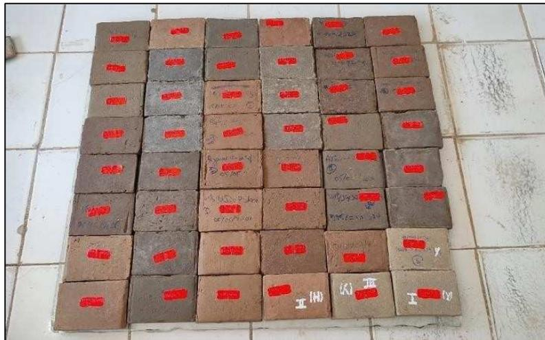
Figure II.51 : Briques en terre crue sèches
