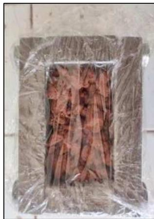
Figure II.48 : Argile dans le moule à brique
