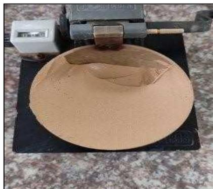
Figure II.29 : Mise en place de la pâte dans la coupelle
