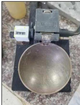
Figure II.26 : Appareille de CASAGRANDE
