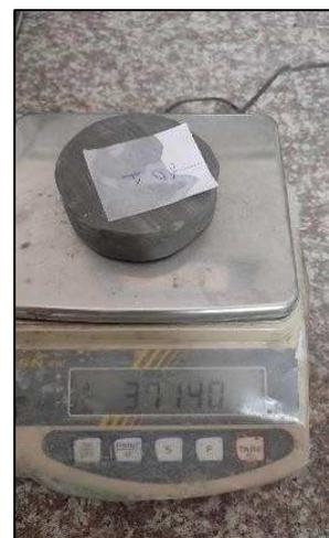
Figure II.6 : Pesage du cylindre
