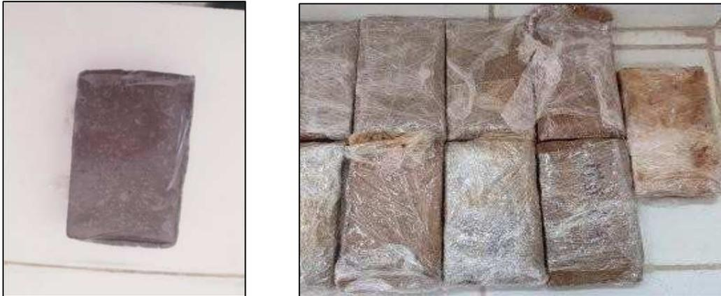
Figure II.50 : Briques en terre crue emballés dans du papier film
