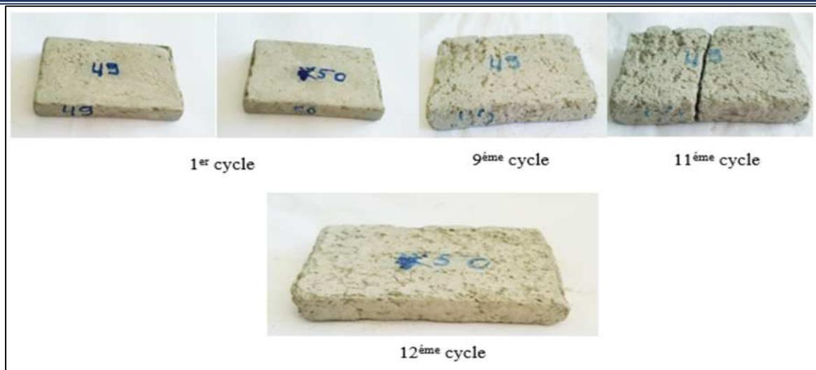
Figure IV.13 : dégradation des briques de l'échantillon d'Akbou+ 8% ciment
