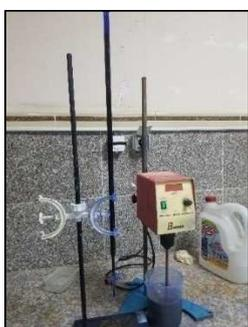
Figure II.44 : Système de dosage du VB
