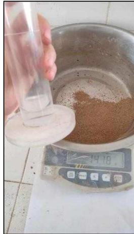
Figure II.47 : Pesage eau + échantillon
