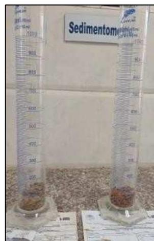
Figure II.13 : Sol mis dans des éprouvettes Gradués
