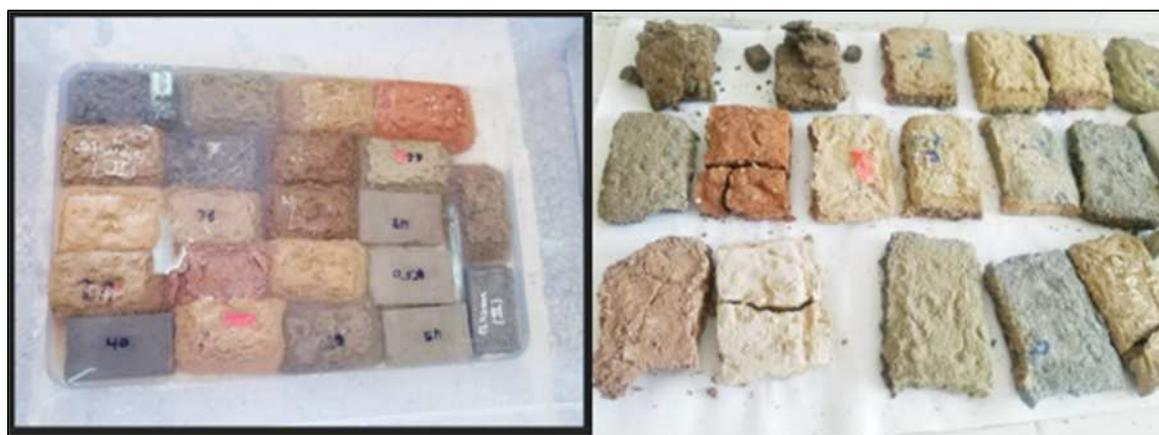
Figure IV.9 : dégradation des briques des l'échantillons sans ajout
