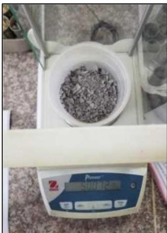
Figure II.12 : Pesage de L'échantillon
