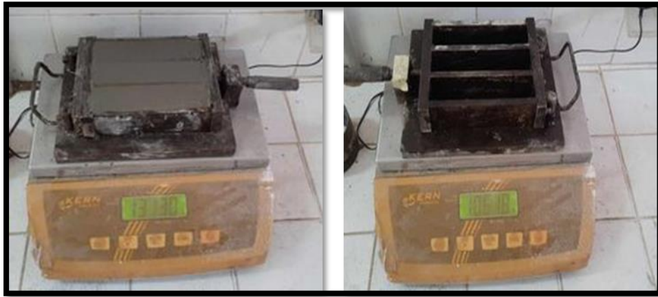
Figure II-14: Essai de la masse volumique fraîche
