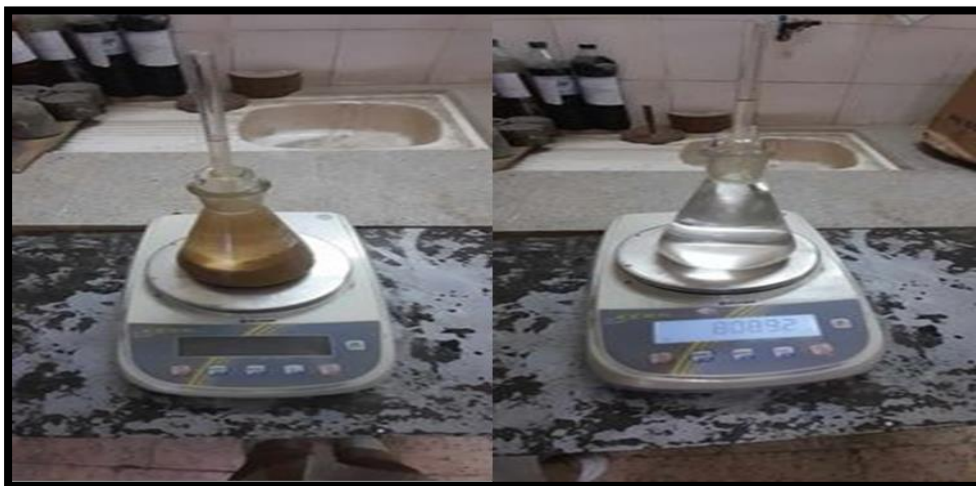
Figure II-8: La masse volumique absolue par la méthode de pycnomètre
