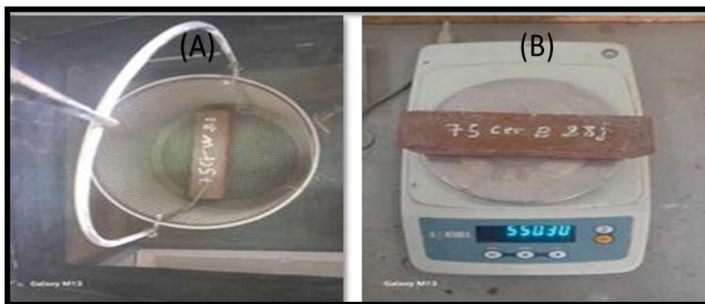
Figure II-15: (A) La pesée hydrostatique ; (B) La masse humide.
