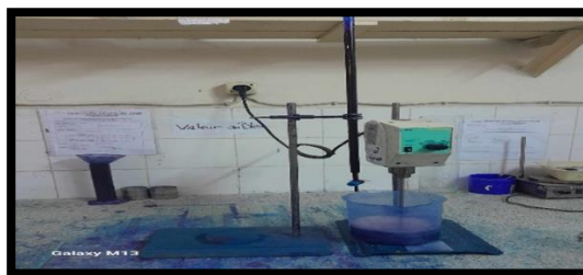
Figure II-7: Appareil d'essai de bleu de méthylène
