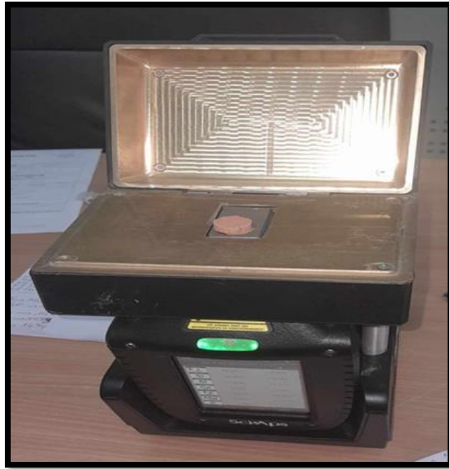
Figure II-13: L'appareil de spectromètre de fluorescence des rayons X (FRX).
