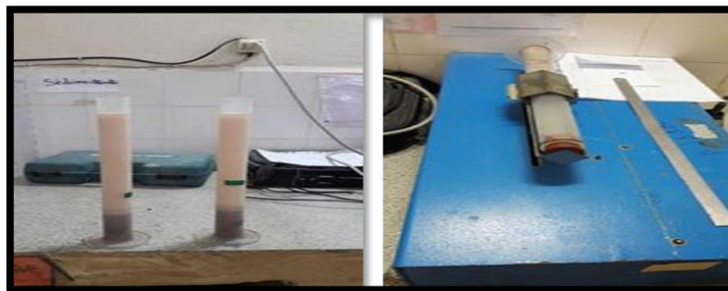
Figure III-7: Essai d'équivalent de sable.
