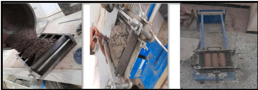
Figure IV-3: Remplir le moule et le mettre dans l'appareil à chocs
