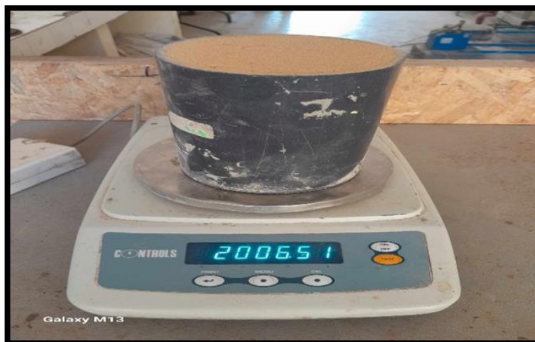
Figure II-10 : La masse volumique apparente
