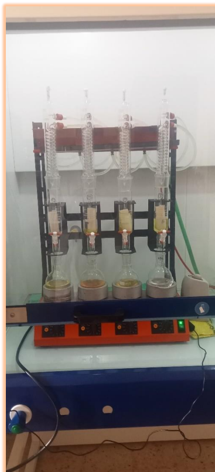
Figure 04 : Extraction de la matière grasse des échantillons à l'aide d'un appareil de type soxhlet.
