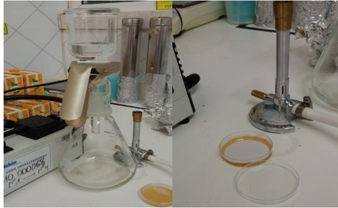
Figure 03 : image Méthode de filtration d'eau et d'écoulement de la membrane filtrante dans le milieu de culture
