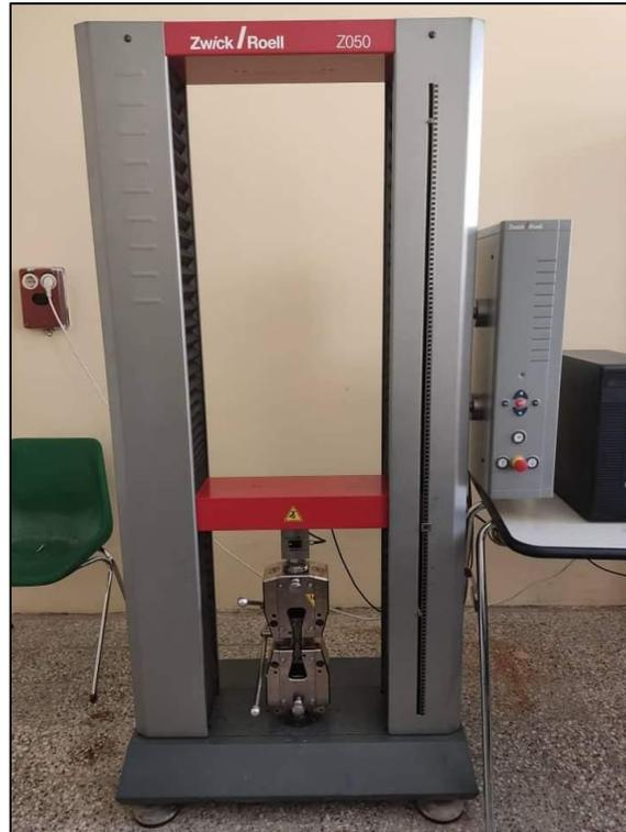
**Fig. II-3** Machine d'essai de traction Zwick/Roell disponible à l'université de Sétif
