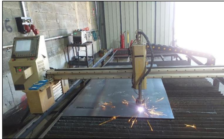
**Fig. I-10** Machine de découpe plasma
