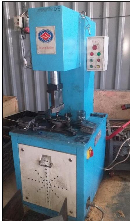
**Fig. I-13** Poinçonneuse hydraulique
