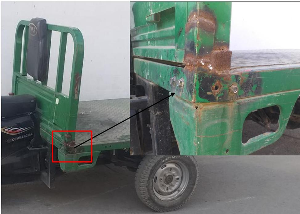
**Fig. III-12** Déformation de la patte de fixation
