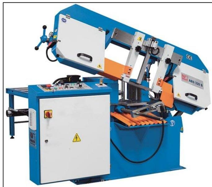
**Fig. I-8** Scies à ruban à coupe droite horizontale ABS 320 B [5]
