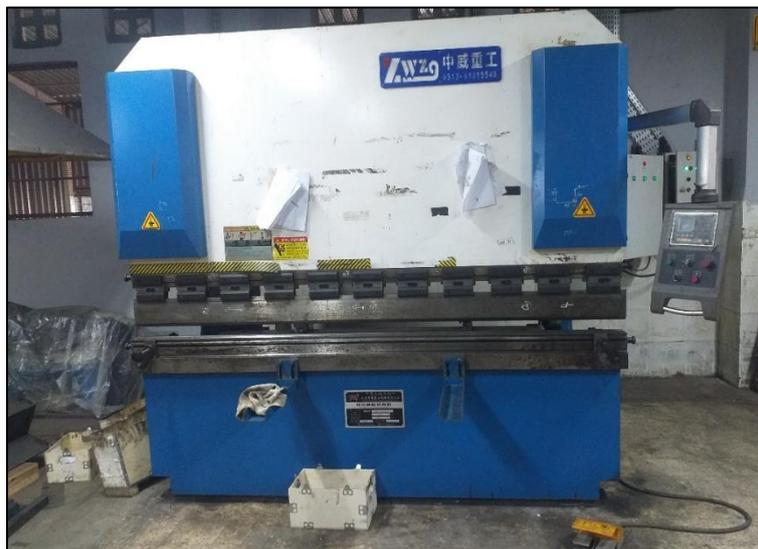
**Fig. I-11** Presse plieuse hydraulique
